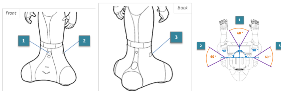
Slika 3.2: Lokacija i vidno polje lasera usmjerenih na okruženje oko robota (prednji, lijevi i desni laser numerirani redom brojevima 1-3)
