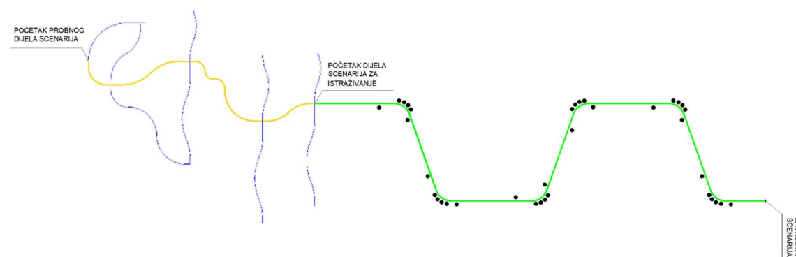
Slika 9. Tlocrtna skica scenarija (Žuta boja = područje „zagrijavanja“; Zelena boja = „testni“ dio; Plava boja = priključne ceste; Crne točke = prometni znakovi)
