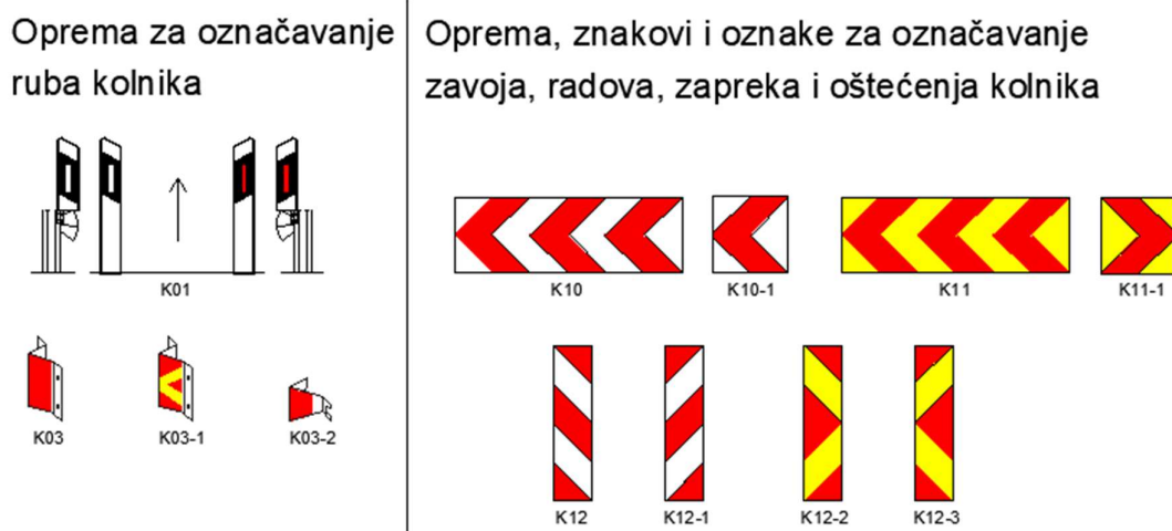
Slika 6. Oprema za označavanje zavoja
