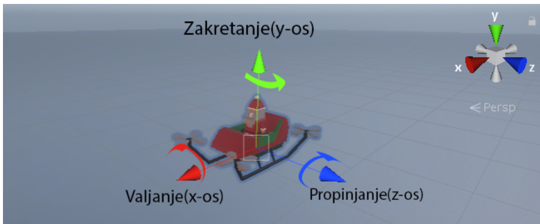
Slika 3.6: Lokalni koordinatni sustav saonica i osi rotacije
