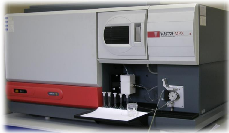
Slika 10. Vista MPX optički emisijski spektrometar induktivno spregnutom plazmom ( engl. Inductively Coupled Plasma - Optical Emission Spectrometer), Varian.
