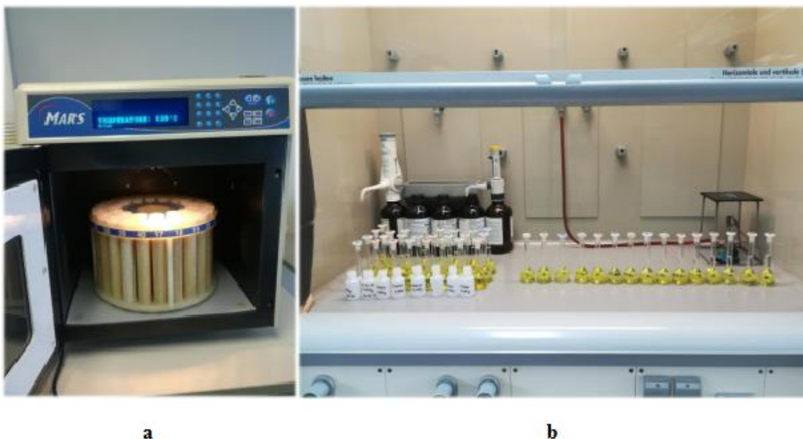
Slika 9. a) MARSXpress mikrovalni sustav (CEM) za razlaganje uzoraka tla u zlatotopci, i
