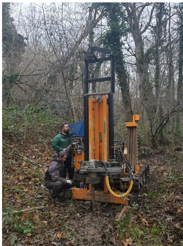
Slika 13: Prikaz istražnog bušenja na poziciji istražne bušotine B1
