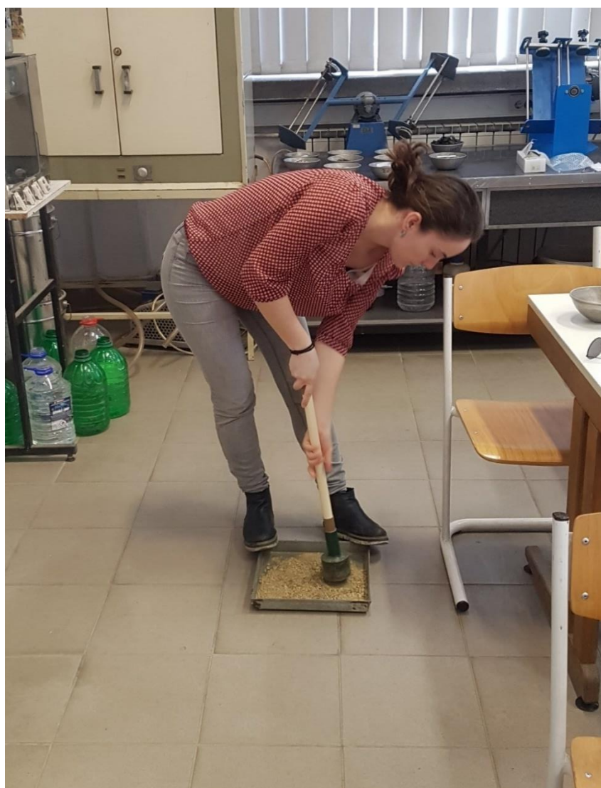
Slika 49: Postupak usitnjavanja osušenog uzorka
