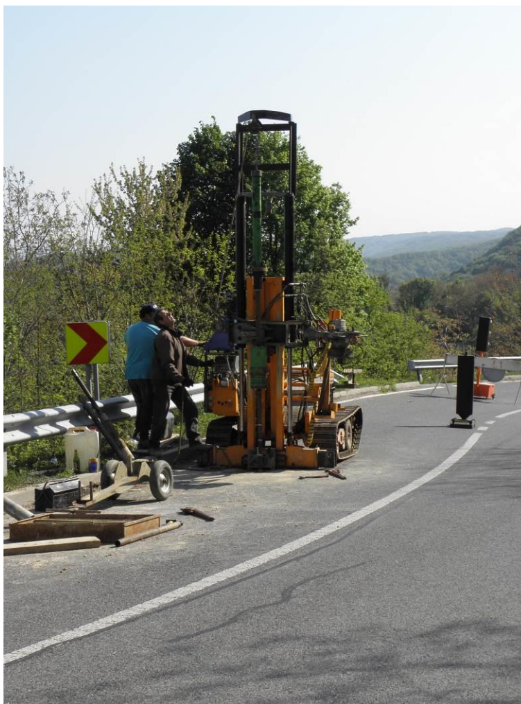
Slika 21: Istražno bušenje i standardni penetracijski pokus na poziciji istražne bušotine B1
