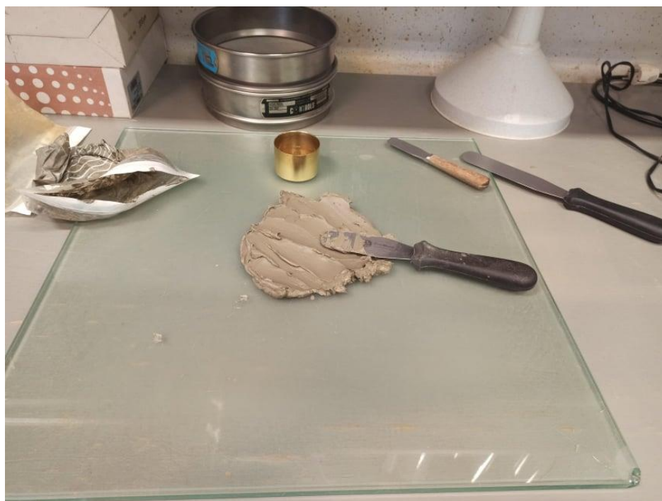
Slika 42: Pripremljen uzorak za određivanje granice tečenja
