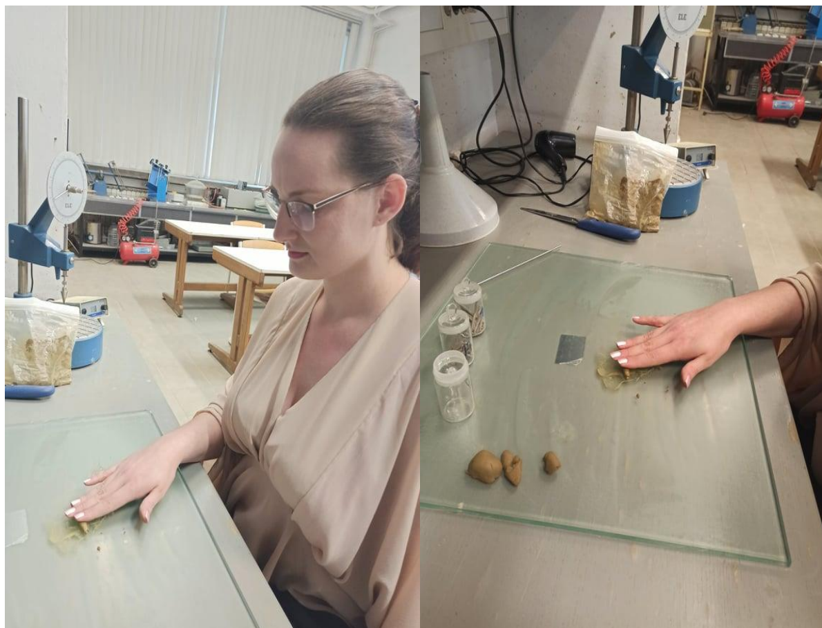
Slika 45: Postupak valjanja valjčića za određivanje granice plastičnosti
