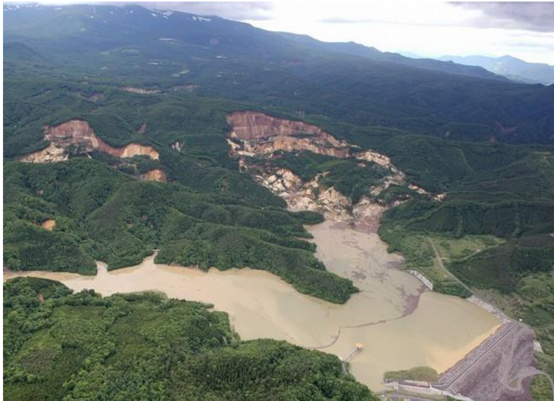
Slika 3: Klizište u blizini Aratozawa brane u Japanu nastalo kao rezultat potresa Iwate-Miyagi, magnitude 6.9, iz 2008. godine, preuzeto iz [4]
