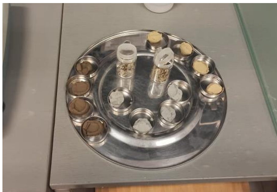
Slika 46: Valjčići nakon završetka pokusa i uzorci za određivanje vlažnosti
