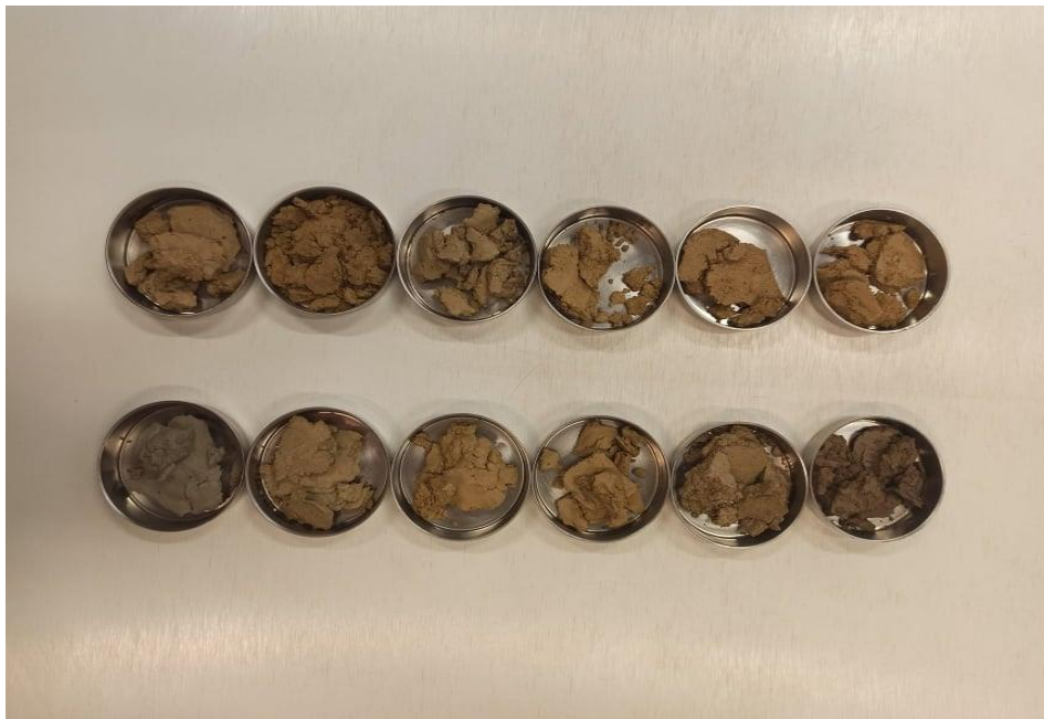
Slika 44: Uzimanje uzoraka za određivanje vlažnosti nakon pokusa padajućeg šiljka
