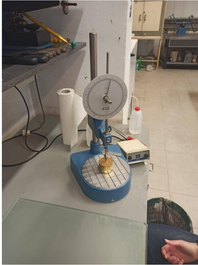
Slika 54: Pokus padajućeg šiljka pri određivanju nedrenirane čvrstoće (nakon pokusa)
