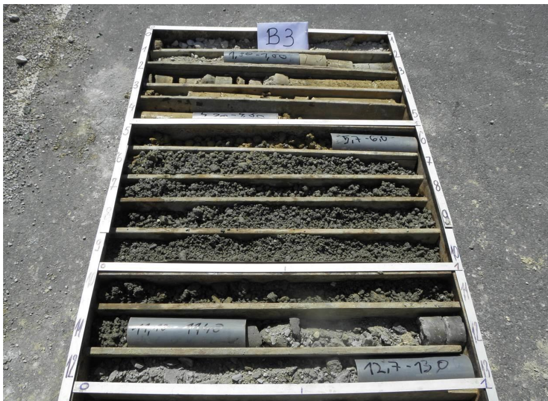
Slika 23: Prikaz jezgre bušotine na poziciji istražne bušotine B3
