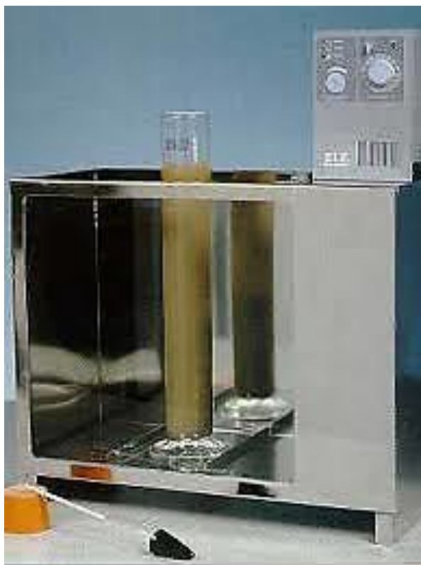
Slika 37: Pripremljeni uzorak u kadi za areometriranje
