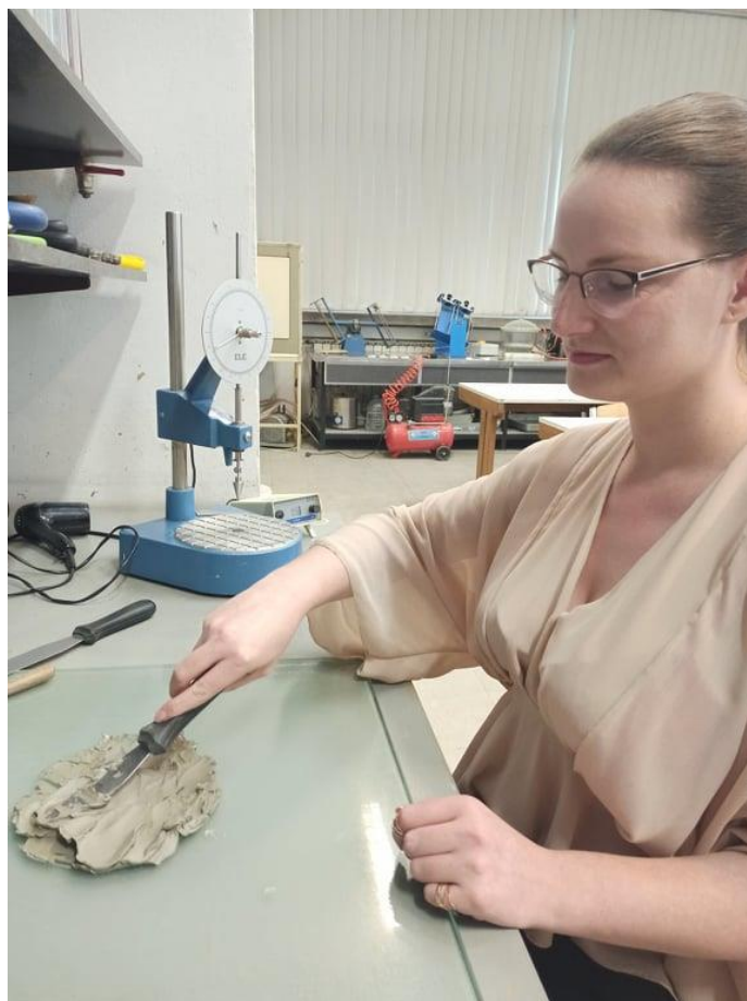
Slika 41: Priprema uzorka određivanje granice tečenja
