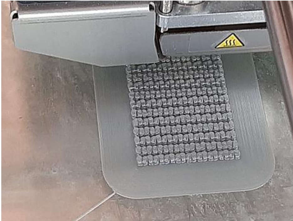
Slika 14. Postupak tiska pločice. Sa strane se nalazi potporni omotač koji je potrebno ukloniti.
