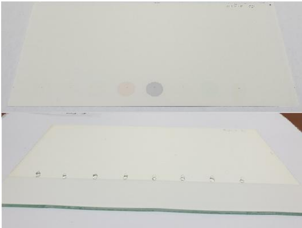
Slika 10. (Gornja slika) Pločica koja ne sadrži hidrofobni sloj i (Donja slika) pločica koja sadrži hidrofobni sloj.
