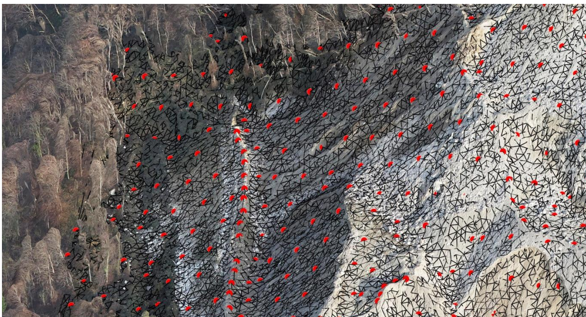
Slika 23 – Izdvojena površina terena bez vegetacije s prikazom kontrolnih točaka i triangulirane površine terena
