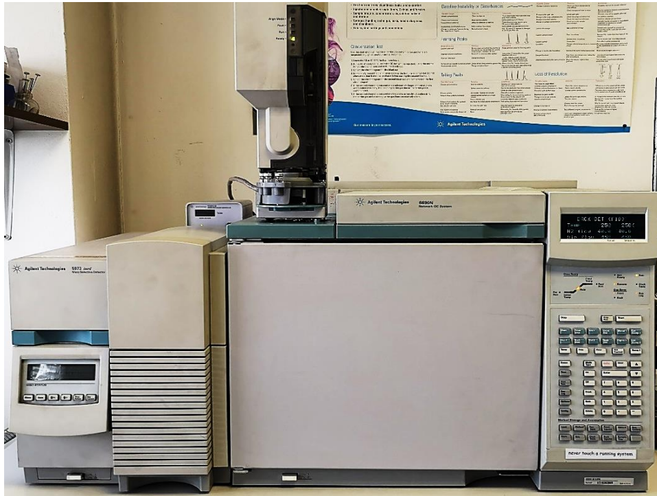
Slika 12. Plinski kromatograf Agilent Technologies 6890N Network GC System s plameno-ionizacijskim detektorom te masenim detektorom tipa 5973 inert Mass Selective Detector (vlastita fotografija)
