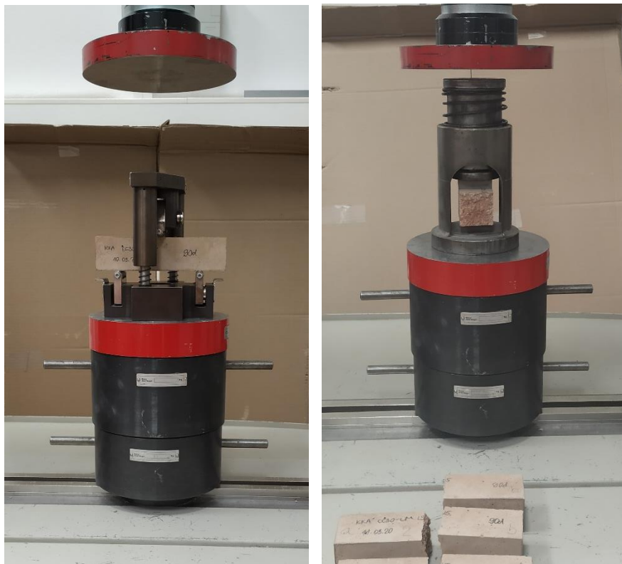
Slika 17 Preša za ispitivanje čvrstoće na savijanje i tlačne čvrstoće
