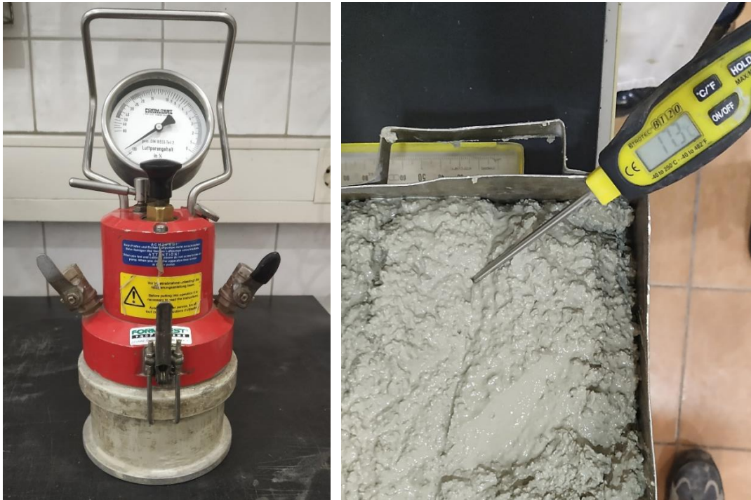
Slika 15 Uređaj za ispitivanje pora i temperature svježe mješavine
