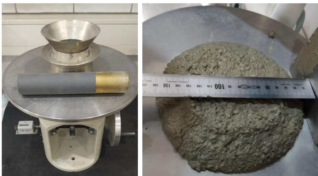
Slika 16 Potresni stolić za mjerenje konzistencije
