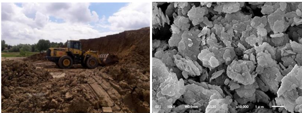
Slika 5 a) Odlagalište gline[8], b) čestice gline snimljene skenirajućim elektronskim mikroskopom (SEM) [9]
