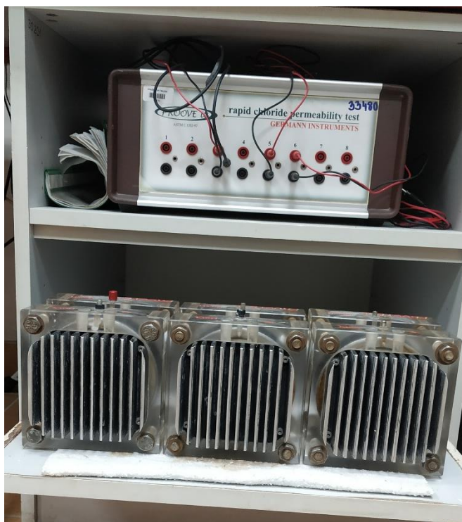
Slika 18 Uređaj za ispitivanje prodora klorida
