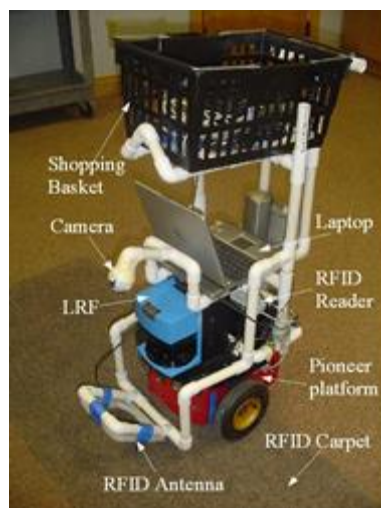
Slika 1: Prikaz komponenti RoboCarta [23]
