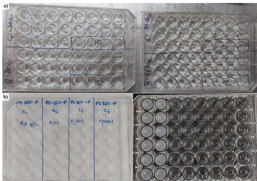
Slika 25. Prikaz 48-pločice: a) s pripremljenom pozitivnom kontrolom 3,4-DCA (desno) i solvent kontrolom DMSO (lijevo) i b) preliminarni pokus izlaganja embrija zebrića PS-u, veličine čestica 0,25 \mu\text{m} i koncentracijama 0,1; 0,01; 0,001 i 0,0001 g/L.
