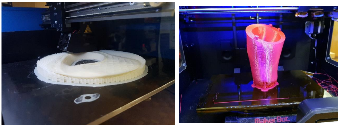
Slika 7.3 Prikaz 3D tiskanja gornjeg dijela proteze
