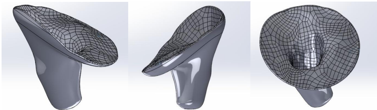
Slika 6.8 3D model gornjeg dijela proteze
