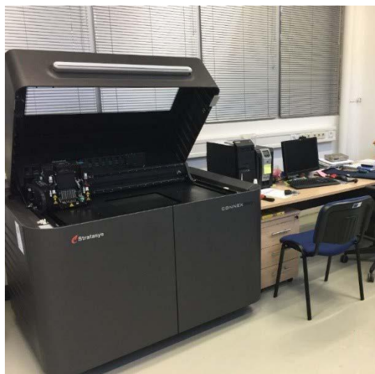
Slika 7.4 3D pisac Connex 350
