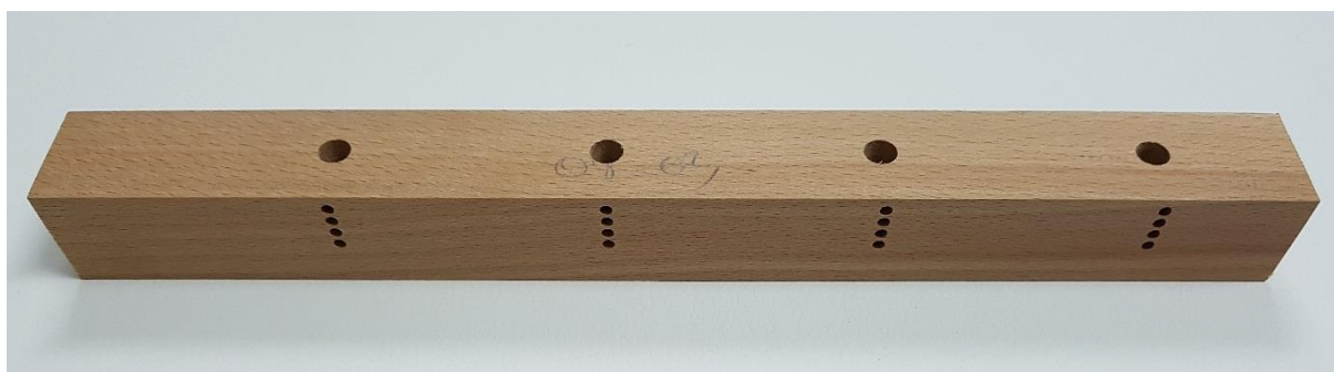
Slika 8. Ispitni uzorak bukovine
