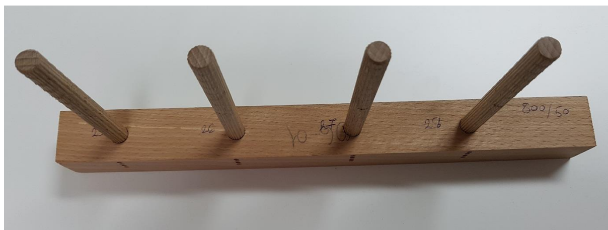
Slika 18. Zavareni uzorak pripremljen za ispitivanje
