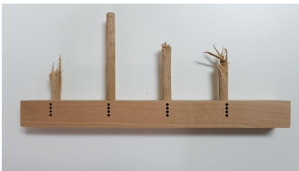
Slika 23. Pucanje moždanika uslijed velikih sila pri zavarivanju (865_50)
