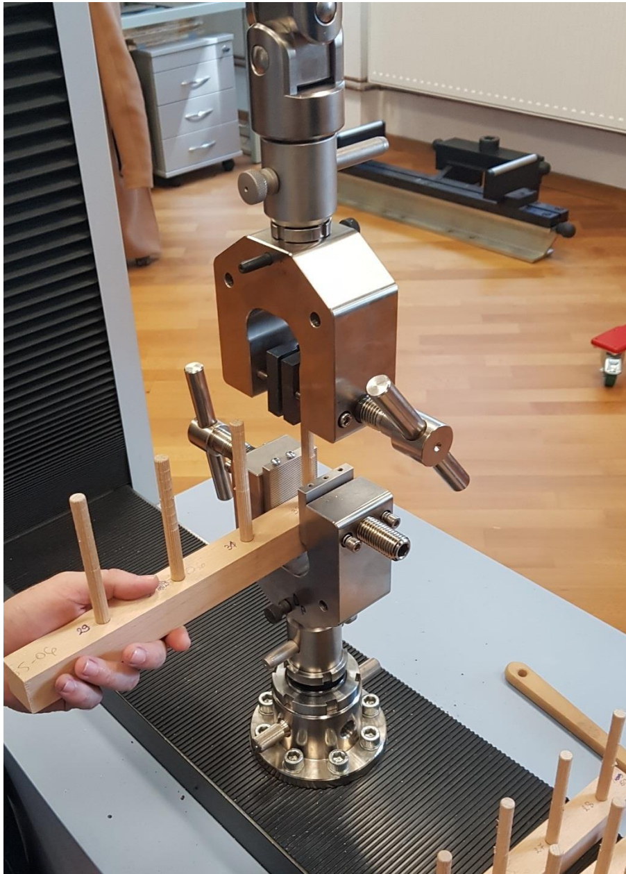
Slika 21. Priprema uzorka za ispitivanje izvlačne sile
