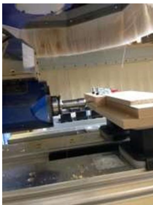
Slika 11. Bušenje provrta za sonde
