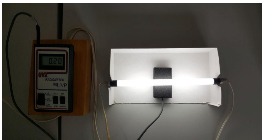
Slika 7. UVP UVX radiometar za mjerenje intenziteta zračenja
