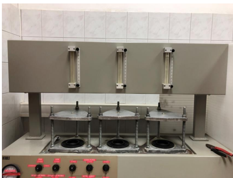
Slika 37. Uređaj za ispitivanje vodopropusnosti betona
