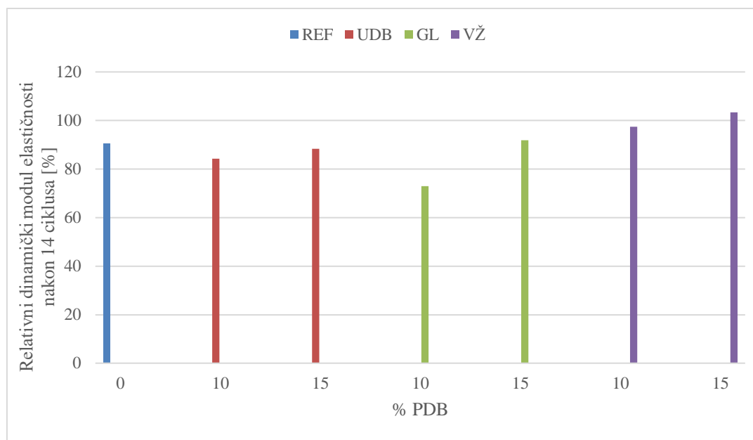
Slika 32. Relativni modul elastičnosti nakon 14 ciklusa
