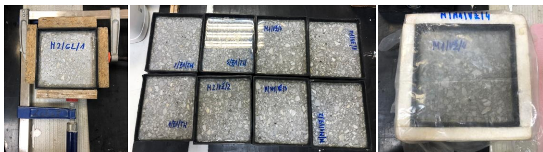
Slika 27. Uzorci za ispitivanje otpornosti na cikluse smrzavanja i odmrzavanja
