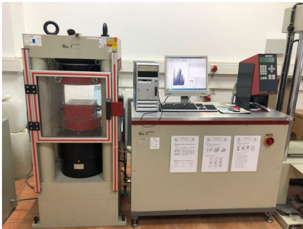
Slika 34. Sustav za ispitivanje tlačne čvrstoće betona
