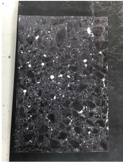
Slika 39. Uzorak za ispitivanje metodom Rapid Air
