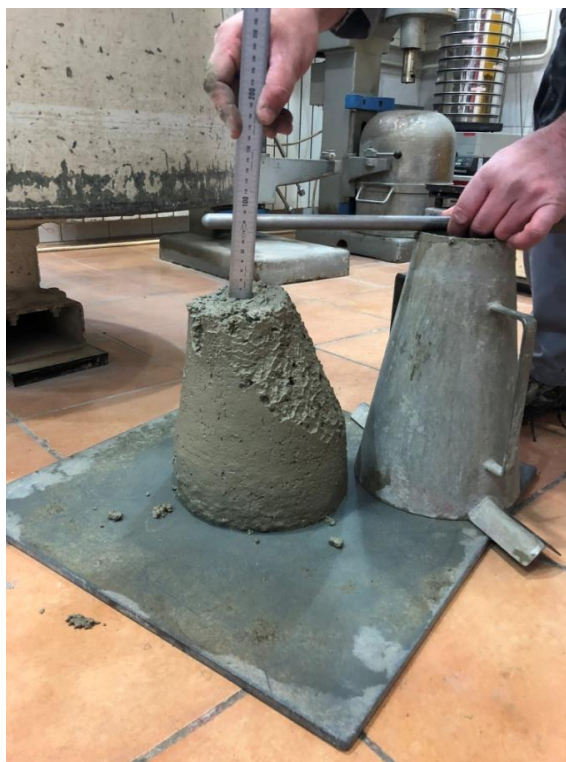
Slika 24. Ispitivanje konzistencije betona slijeganjem
