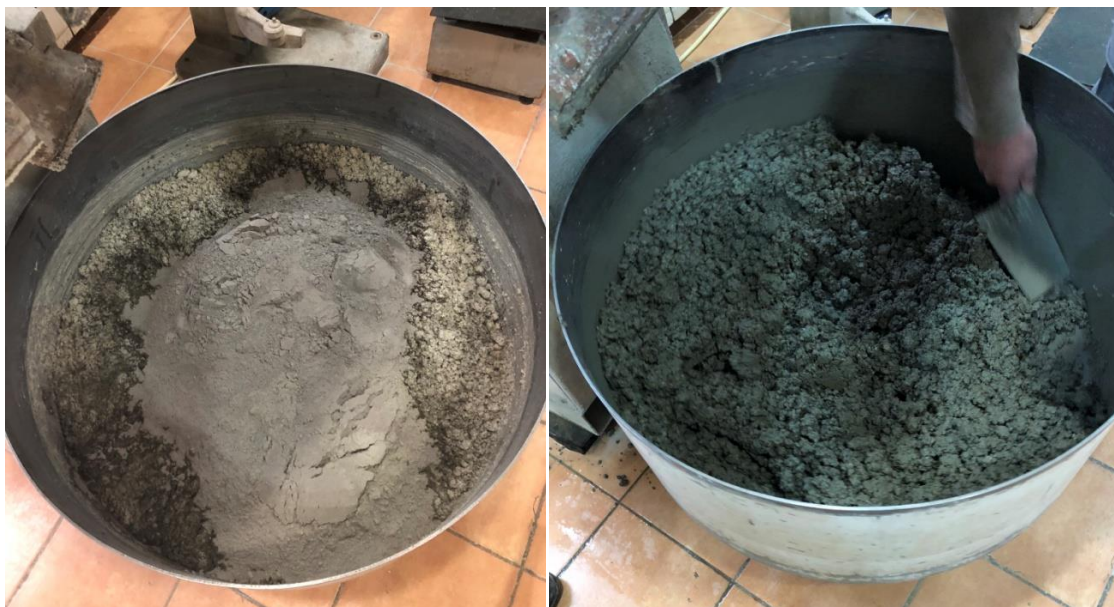
Slika 17. Postupak miješanja betona
