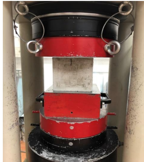
Slika 34. Sustav za ispitivanje tlačne čvrstoće betona
