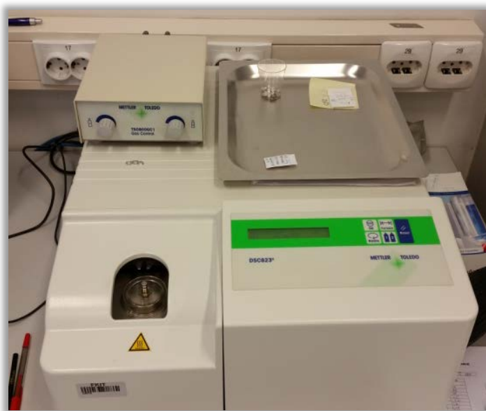
Slika 15. Fotografija diferencijalnog pretražnog kalorimetra Mettler Toledo DSC823 o (Mettler-Toledo AG, Greifensee, Švicarska Konfederacija)
