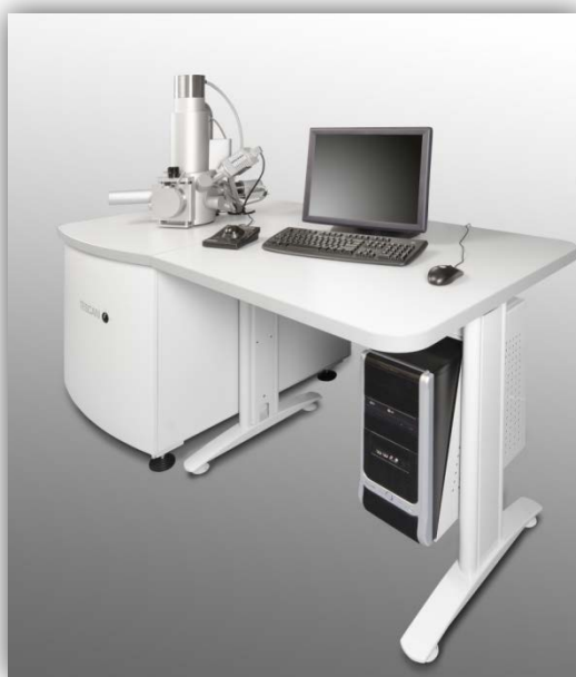
Slika 19. Fotografija pretražnog elektronskog mikroskopa VEGA3 SBH Easy Probe (TESCAN, Brno, Republika Češka)
