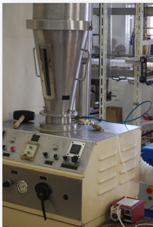
Slika 13. Fotografija granulatora s fluidiziranim slojem Uni-Glatt (Glatt GmbH, Binzen, Savezna Republika Njemačka)
