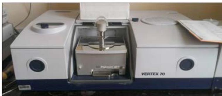
Slika 16. Fotografija FTIR spektrofotometra Vertex 70 s platinastim detektorom (Bruker, Billerica, Sjedinjene Američke Države).
