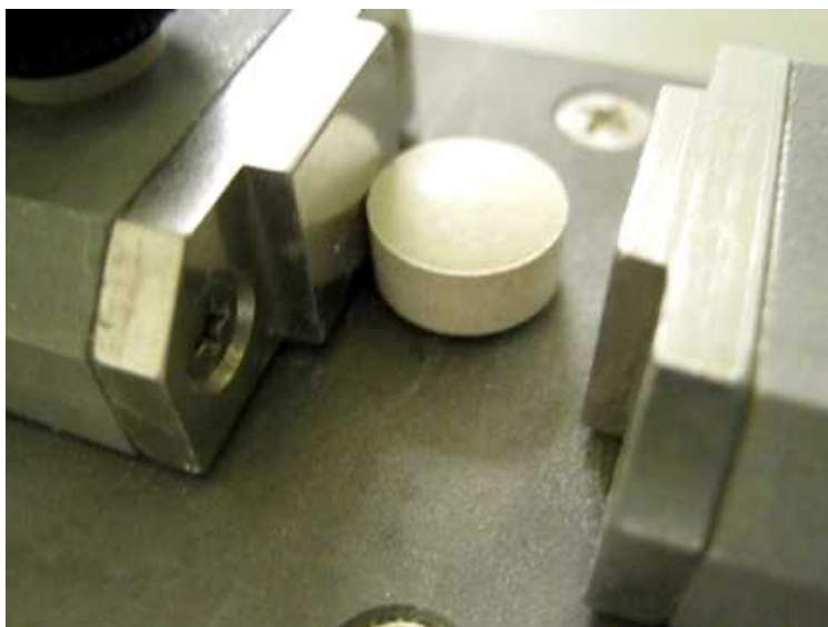
Slika 22. Fotografija dijela uređaja za mjerenje tvrdoće tableta
