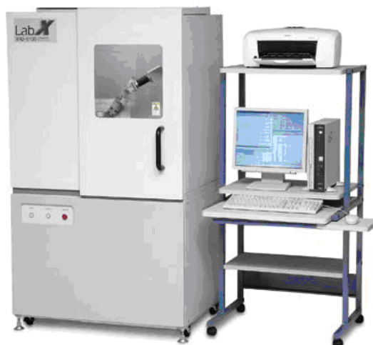
Slika 18. Fotografija uređaja za rendgensku difrakciju praha XRD-6300 (Shimadzu, Kyoto, Japan)
