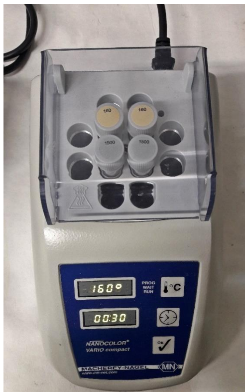
Slika 12: Spektrofotometar Heating block NANOCOLOR VARIO C2 (proizvođač Macherey Nagel) korišten za određivanje vrijednosti KPK.
