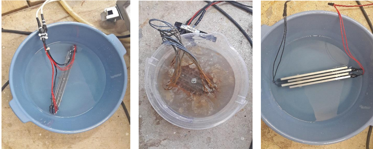
Slika 4: Setovi elektroda postavljeni okomito na dno reakcijske posude.
