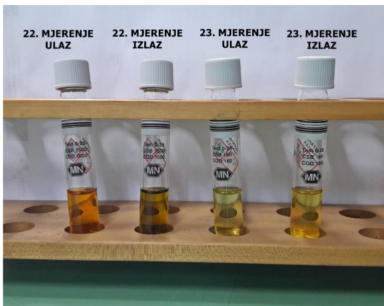
Slika 20: Prikaz reagensa za mjerenje KPK prije i nakon procesa elektrokoagulacije.
