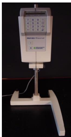
Slika 10. Rotacijski reometar „Rheometric Scientific RM – 180“ (Anonymous 10)
