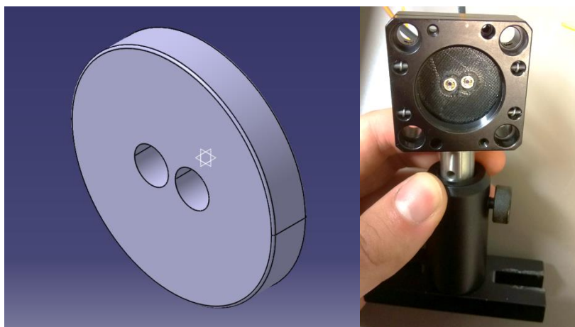
Slika 22 CAD model nosača (lijevo) i nosač s ugrađenim fotodiodama (desno)
