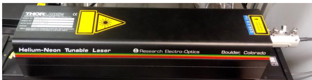
Slika 10 Thorlabs HTPS-EC-1 laserski izbor svjetlosti
