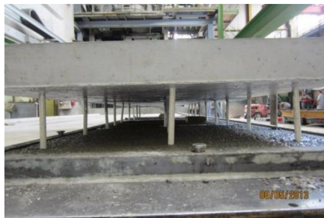
a) odstupanja u položaju polimernih kompozitnih spona, deformiranje pod težinom nosivog sloja
