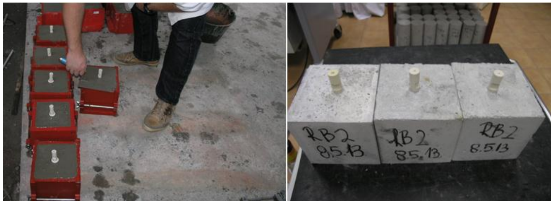
Slika 11-16 Izrada uzoraka za ispitivanje čupanjem
