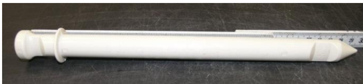
Slika 10-1 Spona ST200 izrađena od polimera visokih uporabnih svojstava
