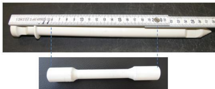
Slika 11-1 Uzorci za ispitivanje dobiveni iz polimernih kompozitnih spona ST200
