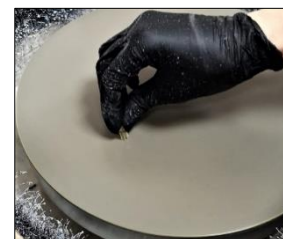
Sl. 19. brušenje i poliranje uzorka (Pripremu uzoraka i analizu izvodila: Valentina Meštrić, fotografirao: prof. Anton Vrlić, Zagreb 2019.)
