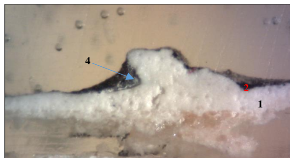
Sl. 26. Uzorak P5 b snimljen pod lupom (povećanje 40x), manje uočljivi agregati, Vidljivi slojevi osnove (1), slikanog sloja (2), sloja arapske gume (4) (fotografirala: Valentina Meštrić, 2019, Zagreb)
