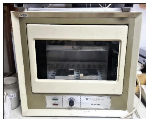
Sl. 16. umjetno sušenje proba u peći Instrumentaria ST-01/02 (fotografirala: Valentina Meštrić, 2019.)
