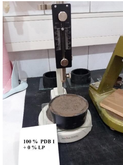
Slika 21. Ispitivanje kraja vezivanja
