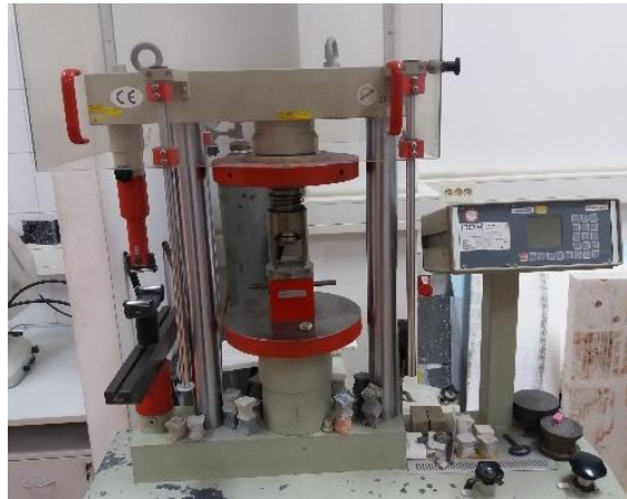
Slika 27. Preša za ispitivanje savojne i tlačne čvrstoće morta
