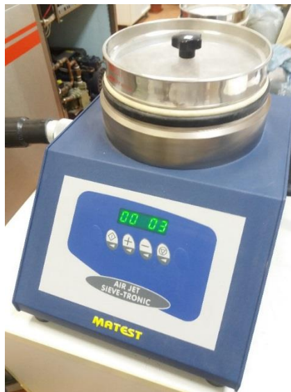
Slika 17. Uređaj za prosijavanje air jet metodom
