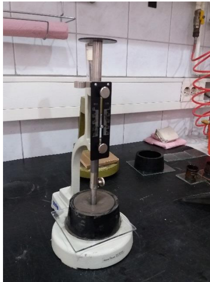
Slika 20. Ispitivanje standardne konzistencije paste
