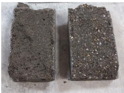
Slika 51. Segregacija kod uzoraka sa PDB 3
