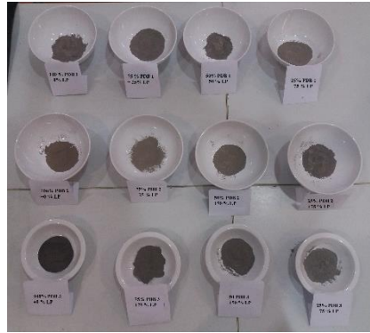
Slika 19. Uzorci veziva sa određivanjem sadržaja slobodne vode
