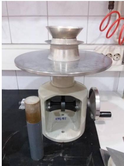
Slika 24. Oprema za ispitivanje konzistencije svježeg morta
