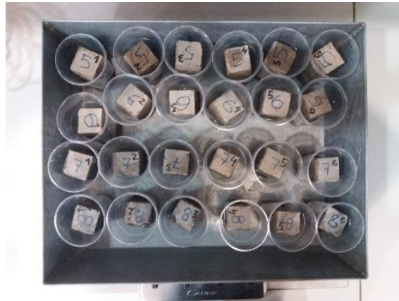
Slika 28. Uzorci za ispitivanje kapilarne vodoupojnosti mortova
