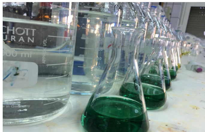
Slika 3 – Analiza vode za ljudsku potrošnju (metoda određivanja amonijaka)
