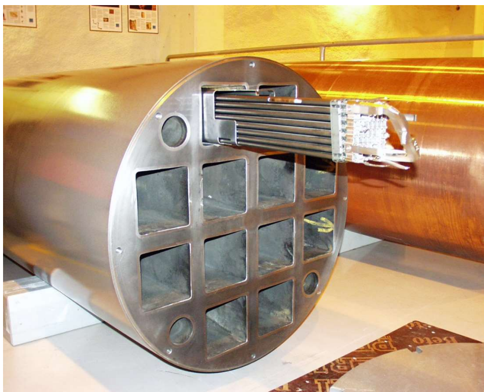
Slika 4-10 Insert – unutrašnja struktura od lijevanog željeza, s jednim ubačenim gorivnim elementom, finski koncept (POSIVA), (izvor: prof.dr.sc. Ivan Vrkljan, privatna zbirka).
