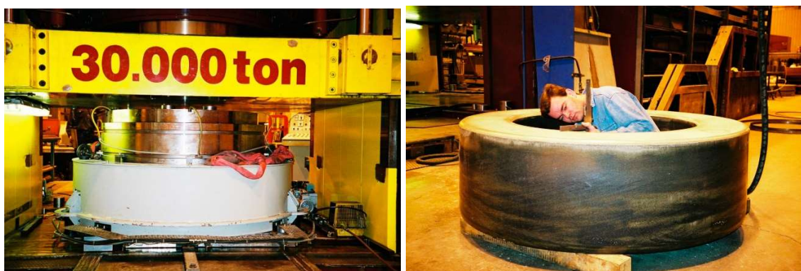
Slika 4-13 Priprema prstenova od bentonita kao materijala zapunjavanja prostora između spremnika i stijene (Bennett, 2012).
