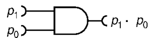
Slika 18: Shema sklopa za množenje pomoću logičkih AND vrata. p_0 i p_1 predstavljaju vjerojatnosti jedinice.
