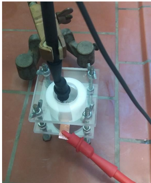
Slika 4.12. Elektrokemijska ćelija spojena na izvor istosmjerne struje; crvena žica anoda, crna žica katoda.
