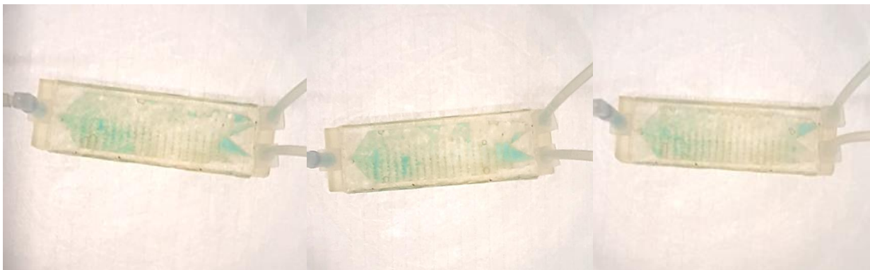
Slika 57. Separator SiO 2 -Teflon (1U:1V) nakon 120 sekundi
