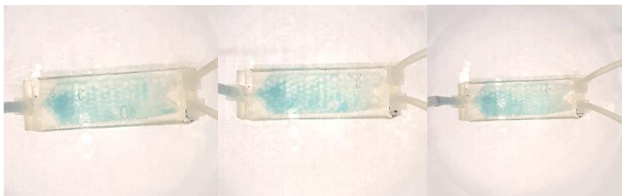
Slika 34. Separator #2 (2U:1V) nakon 30 sekundi
