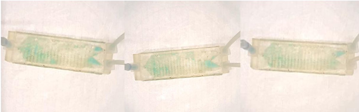
Slika 56. Separator SiO 2 -Teflon (1U:1V) nakon 90 sekundi
