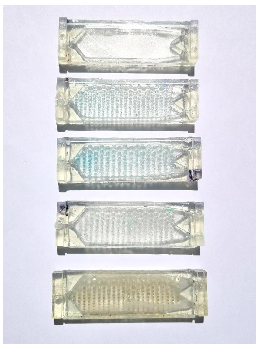
Slika 18. Separatori ispisani na pisaču Form 2
