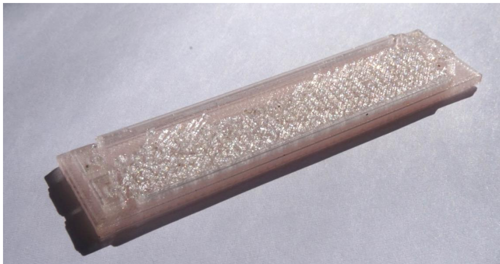
Slika 17. Separator ispisan na pisaču M200 od materijala Z-Glass
