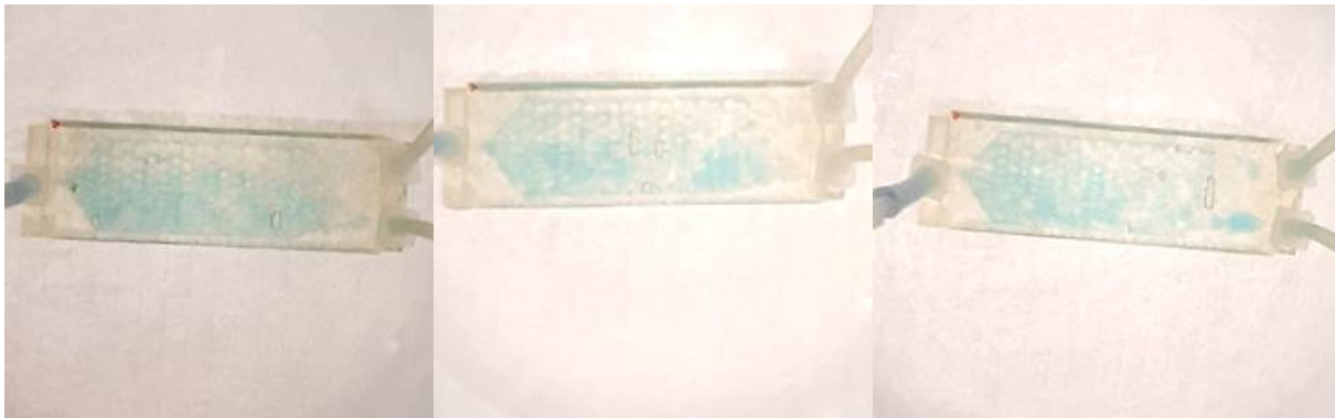
Slika 25. Separator #1 (2U:1V) nakon 120 sekundi
