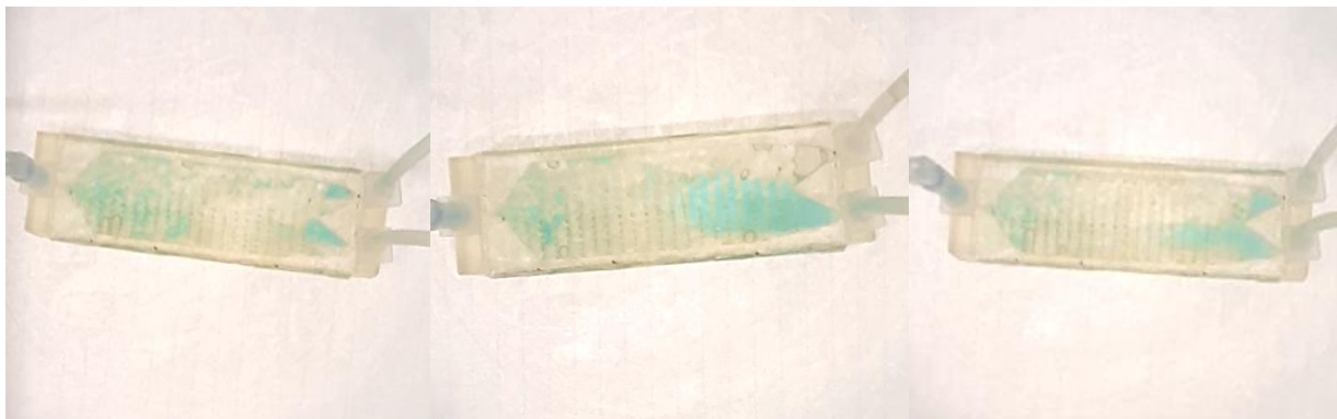
Slika 54. Separator SiO 2 -Teflon (1U:1V) nakon 30 sekundi
