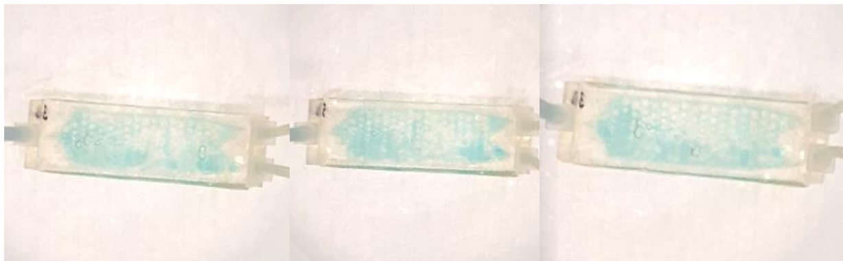
Slika 48. Separator #3 (2U:1V) nakon 90 sekundi
