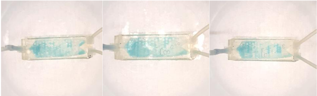
Slika 40. Separator #2 (1U:2V) nakon 90 sekundi
