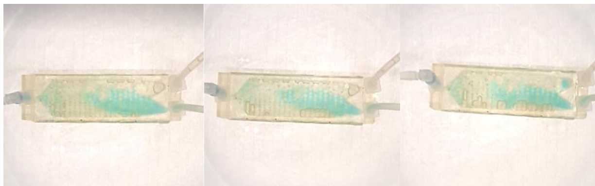
Slika 62. Separator SiO 2 -Teflon (1U:2V) nakon 30 sekundi
