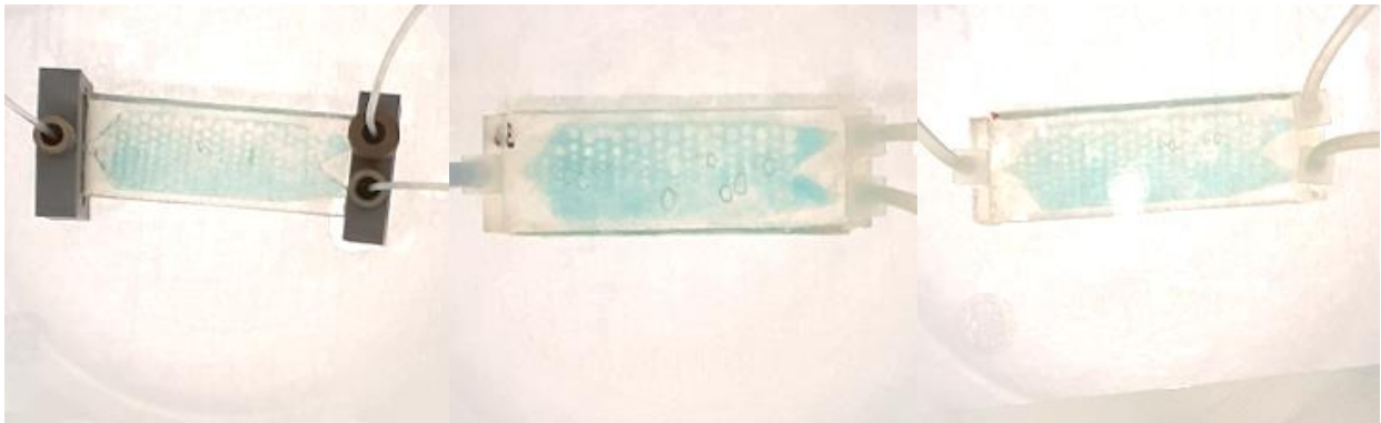
Slika 21. Separator #1 (1U:1V) nakon 120 sekundi
