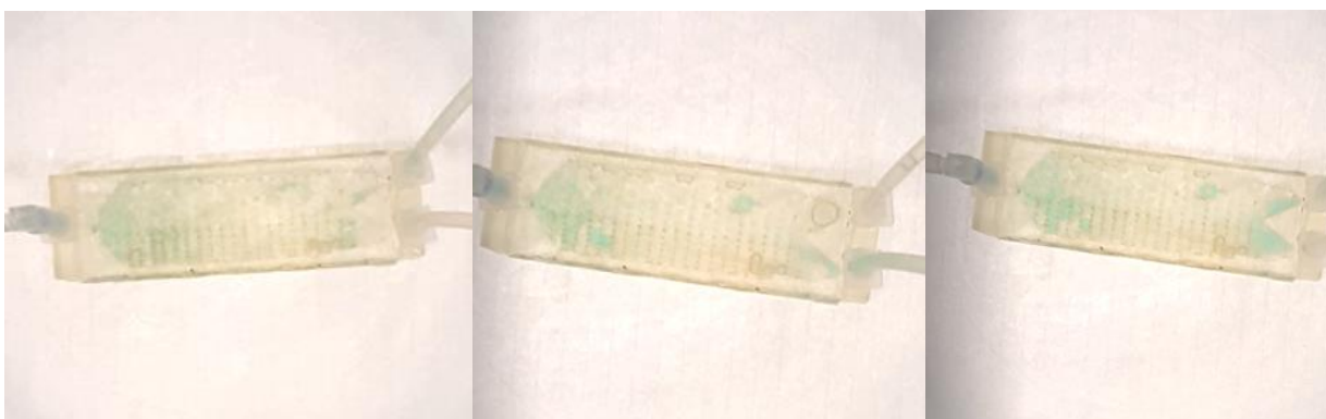
Slika 59. Separator SiO 2 -Teflon (2U:1V) nakon 60 sekundi
