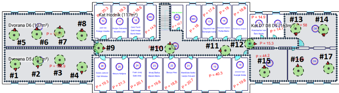
Slika 18 Prikaz rasporeda pristupnih točaka i usmjerenja antena na katu (crvena strelica).
