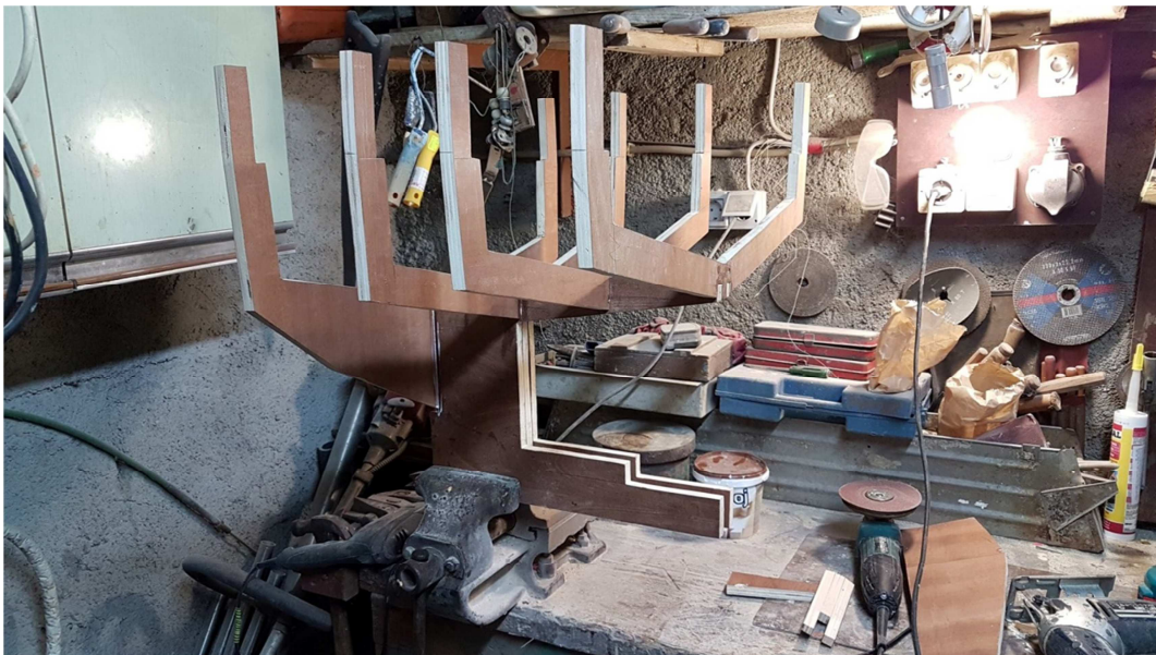
Slika 4.8. Rebra postavljena na kobilicu broda
