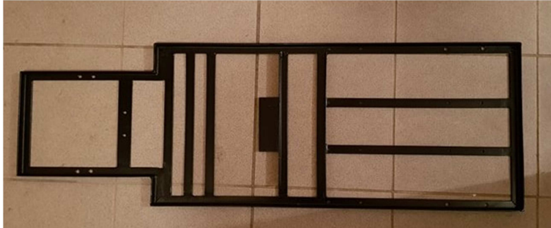
Slika 3.11. Izrađena šasija vozila
