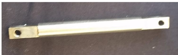
Slika 3.10. Izraden rukavac koljenastog vratila
