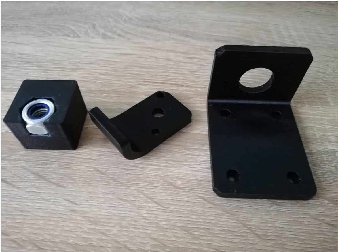
Slika 2.6. Dijelovi izradeni aditivnom tehnologijom 3D ispisa
