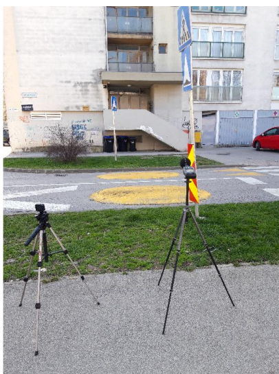
Slika 14. Prikaz tronožaca s GoPro kamerom i zvukomjerom (lijevo), prikaz mjerenja ispitivanja (sredina) te prikaz zaštite protiv vjetra (desno) [14]
