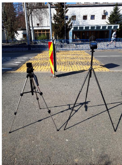
Slika 14. Prikaz tronožaca s GoPro kamerom i zvukomjerom (lijevo), prikaz mjerenja ispitivanja (sredina) te prikaz zaštite protiv vjetra (desno) [14]
