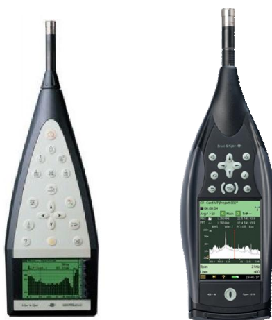
Slika 13. Prikaz zvukomjera B&K 2260 (lijevo) [12] i B&K 2270 (desno) [13]
