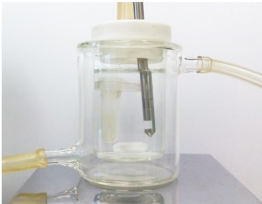
Slika 3.1. Aparatura za mjerenje otpuštanja aktivne tvari iz hidrogela.
