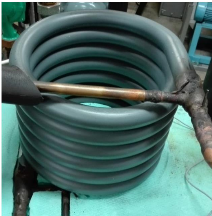
Slika 1.6 Koaksijalni kondenzator mjerne linije
