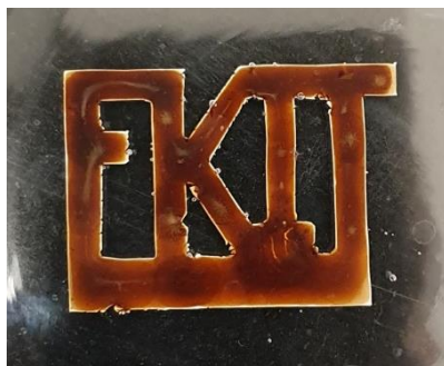
Slika 3.4. GO papir dobiven nakapavanjem na filter papir P-PES
