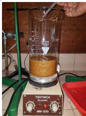
Slika 3.1. a) Mlinac i sito korišteni pri obradi grafita, b) smjesa u ledenoj kupelji i c) smjesa nakon dodavanja otopine \text{H}_2\text{O}_2
