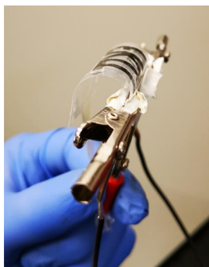
Slika 3.10. Prikaz superkondenzatora sa samostojećim grafenskim papirom tijekom testiranja metodom cikličke voltamerije: a) ravni superkondenzator i b) savijeni superkondenzator
