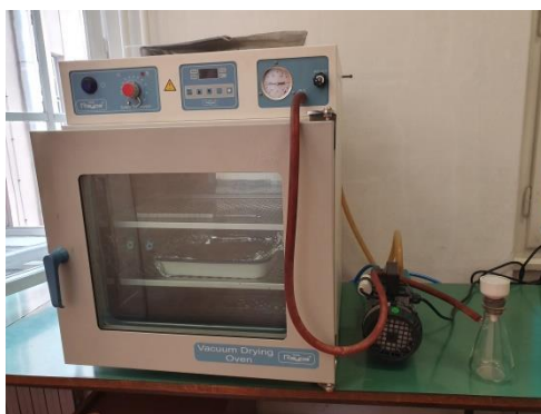
Slika 3.3. Aparatura za vakuum filtraciju
