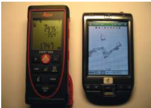
Slika 7. Sustav DistoX za digitalnu izmjeru speleoloških objekata
