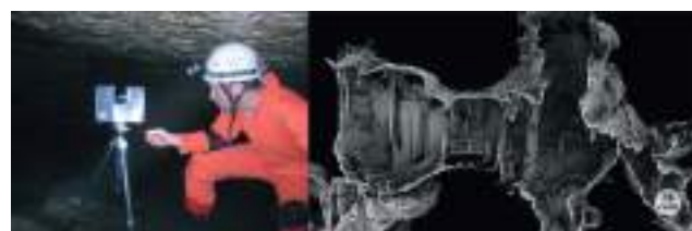
Slika 9. Mjerenje špilje 3D laserskim skenerom (lijevo), oblak točaka špilje (desno)
