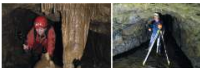
Slika 10. GeoSLAM pri mjerenju špilja
