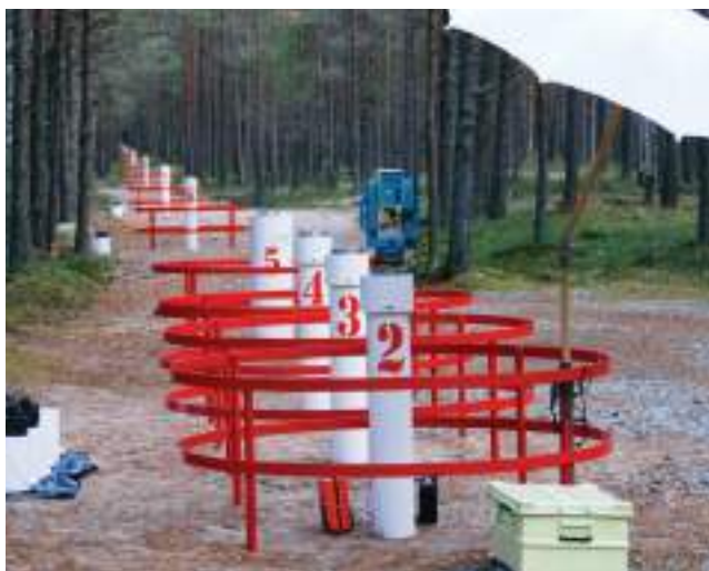
Slika 3.3. Kern ME5000 na kalibracijskoj bazi Vääna (Jokela, 2014).
