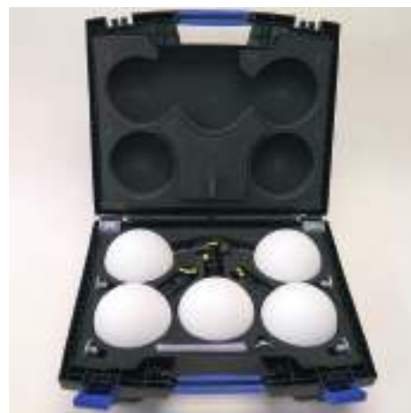
Slika 2. Mjerne mete – sfere
