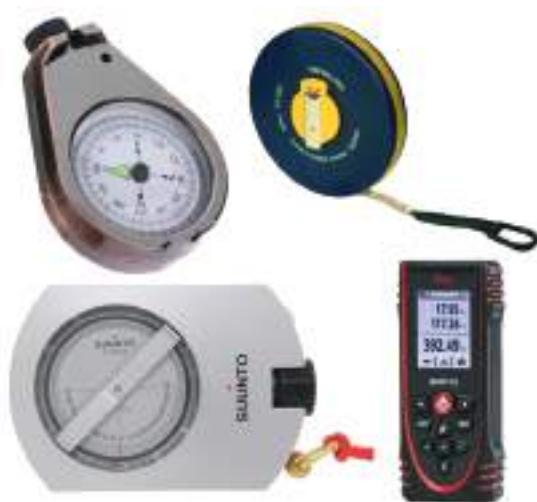
Slika 4. Mjerni pribor koji se koristi za izmjeru speleoloških objekata
