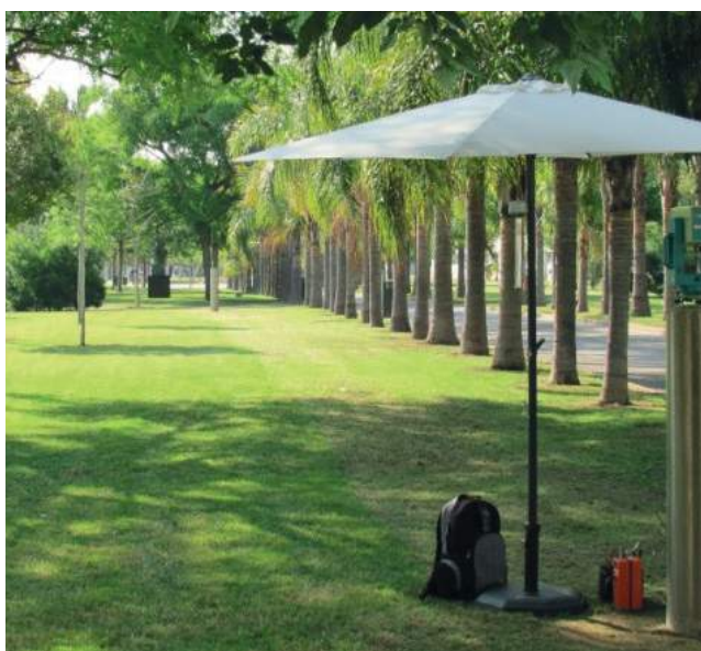
Slika 3.7. Izmjera geodetske bazne linije UPV u Valenciji (Jokela, 2014).
