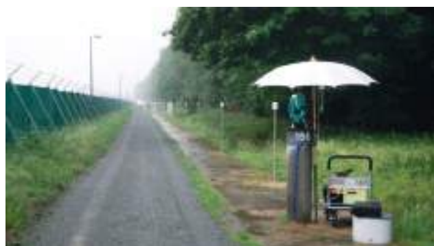
Slika 3.5. Geodetska bazna linija PTB, Braunschweig, opremljena meteorološkim senzorima (Jokela, 2014).
