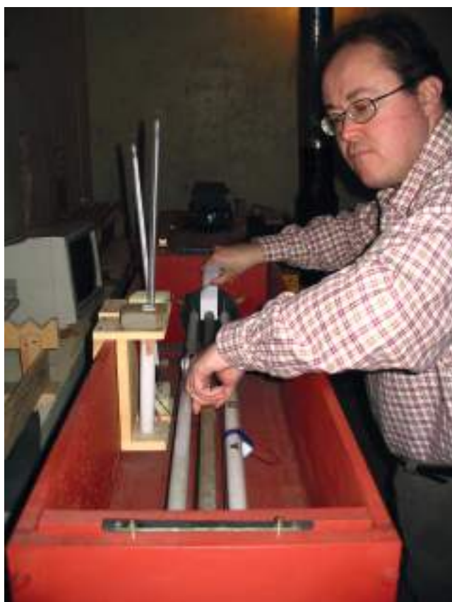
Slika 2.6. Komparacija kvarcnog etalona br. VIII u opservatoriju Tuorla (Jokela i dr., 2009).
