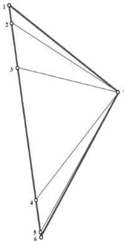
Slika 3.2. Konfiguracija kalibracijske baze Kyviškes (Juceviciute i dr., 2002).
