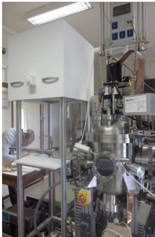
Slika 3: Uređaj za magnetronsko rasprašenje smješten u Laboratoriju za tanke filmove, Instituta Ruđer Bošković.
