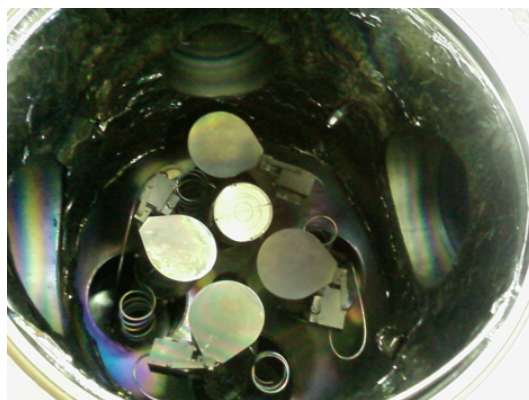
Slika 4: Unutrašnjost vakuumske komore magnetronskog rasprašivača KJLC CMS 18. Vidljiva su četiri magnetrona od kojih je jedan otklopljen (detaljnije u tekstu). Slikano u laboratoriju za tanke filmove Instituta Ruđer Bošković.
