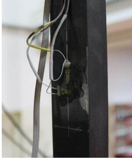
Slika 31. Elektrootporni tenzometri u polumosnoj konfiguraciji
