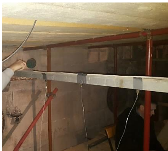
Slika 66. Pobuda zatege udarnim čekićem
