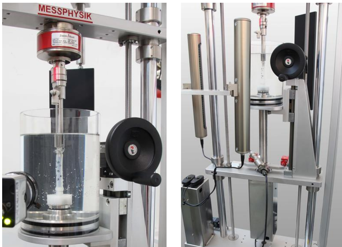
Slika 6 Uređaj za test tlak – istezanje (Zwick-Roell, 2019.)
