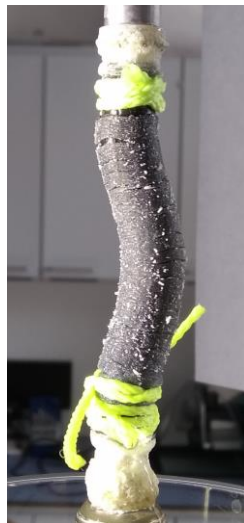
Slika 20 Izvijanje uzorka pri povećanju tlaka
