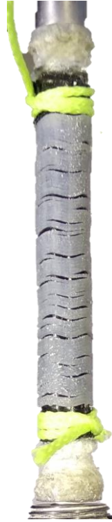
Slika 44 Prikaz pucanja uzdužnih veza među vlaknima pri navlačenju i čišćenju
