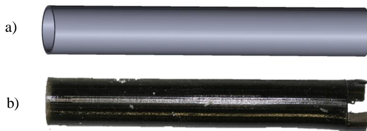
Slika 16 a) CAD model matrice, b) ispisani model
