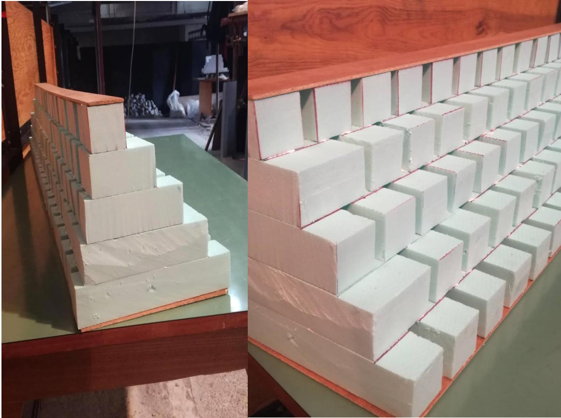
Slika 34. Model propusnog gabionskog zida 2
