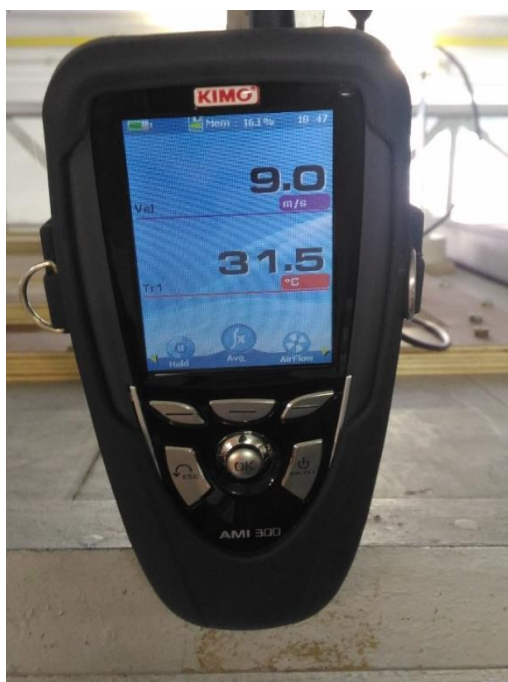
Slika 26. Uređaj za očitavanje brzine i temperature izmjerene u vjetrovnom tunelu pomoću anemometra s vrućom žicom
