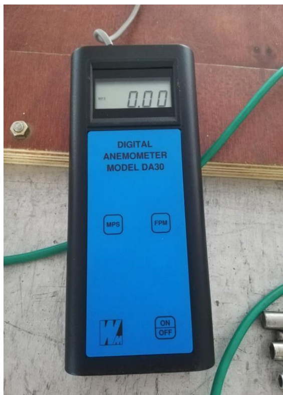
Slika 28. Uređaj za očitavanje brzina anemometra s aerometrijskim krilom
