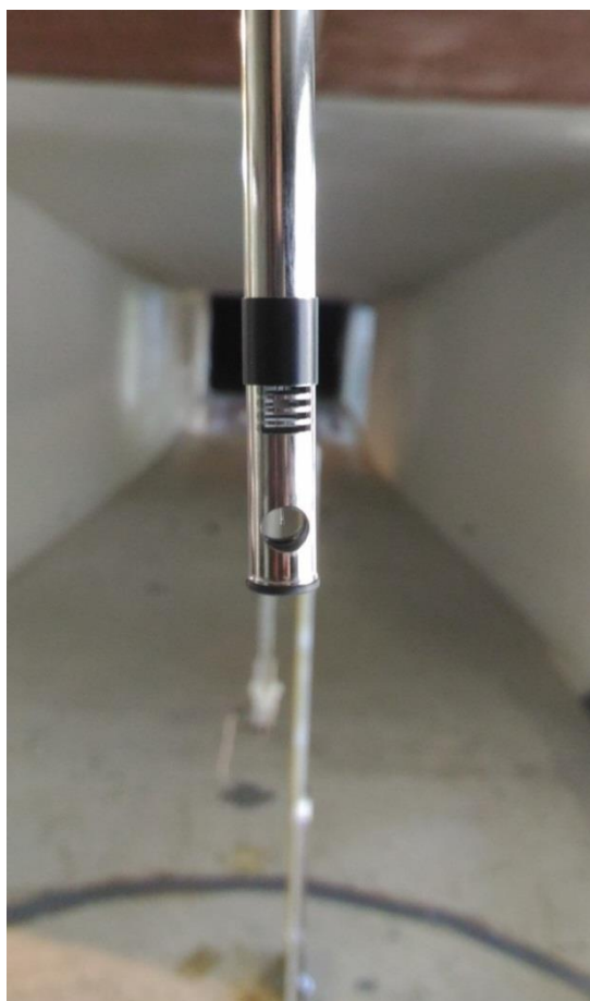
Slika 25. Senzor korištenog anemometra s vrućom žicom
