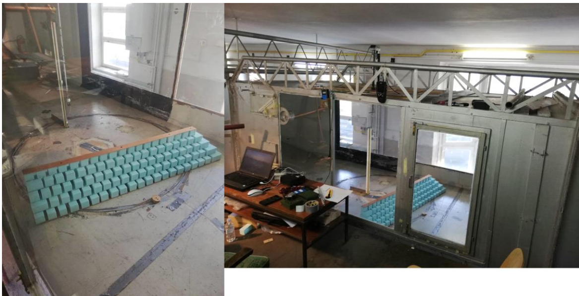
Slika 35. Model propusnog gabionskog zida u vjetrovnim tunelu
