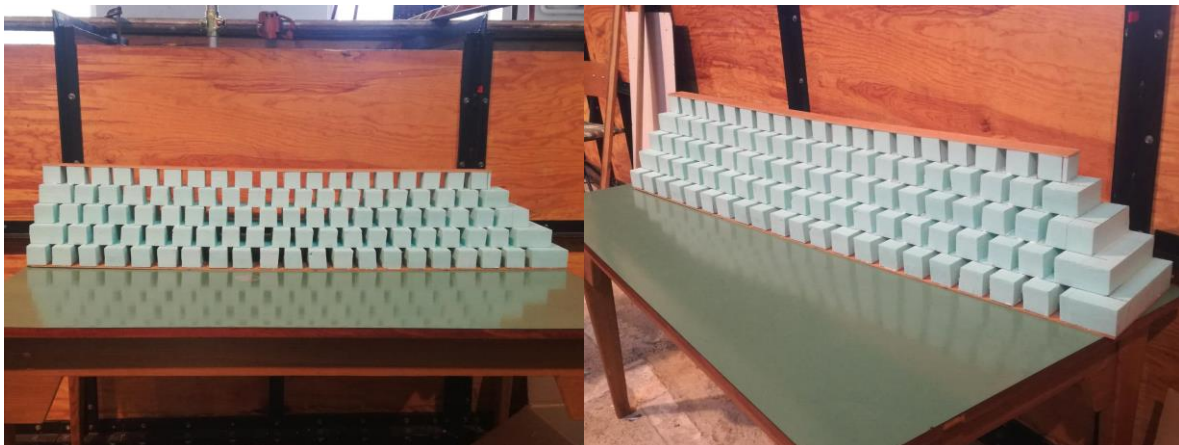
Slika 33. Model propusnog gabionskog zida 1
