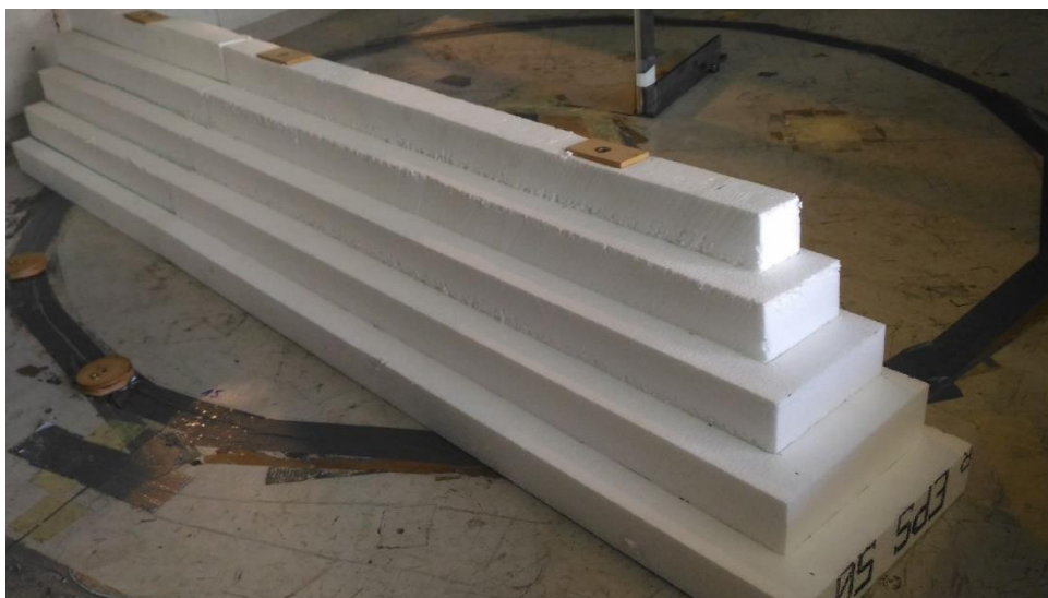
Slika 19. Model nepropusnog gabionskog zida u vjetrovnom tunelu [13]
