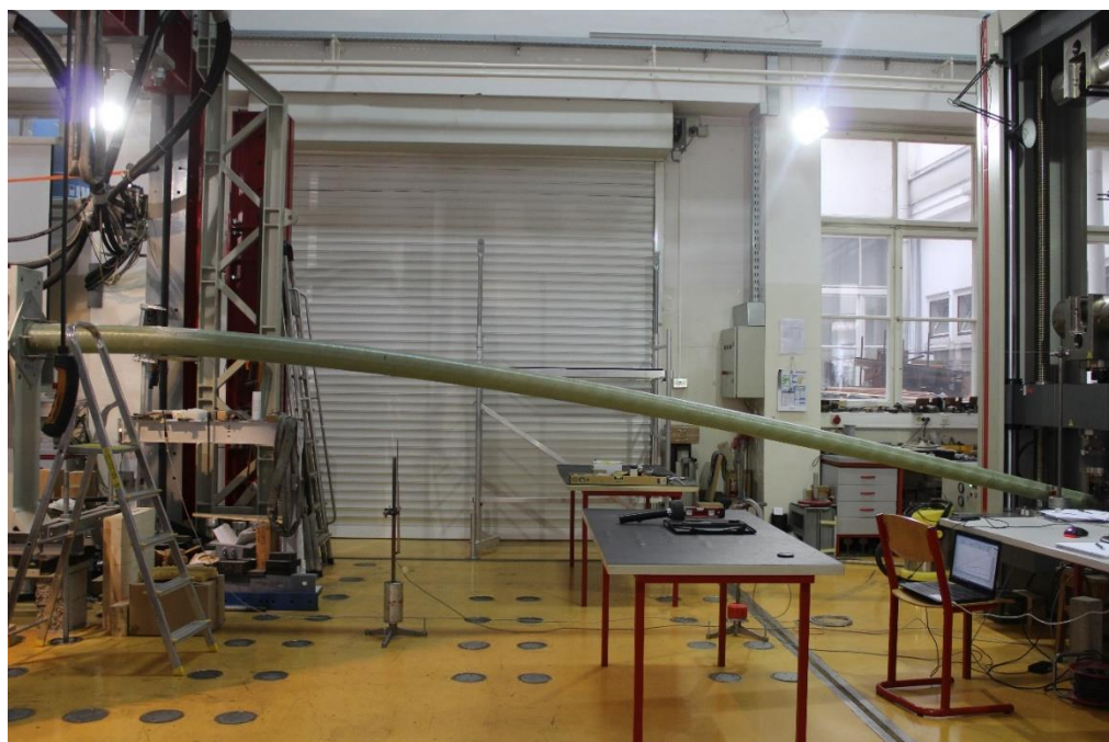
Slika 11. Kompozitni stup na kraju ispitivanja
