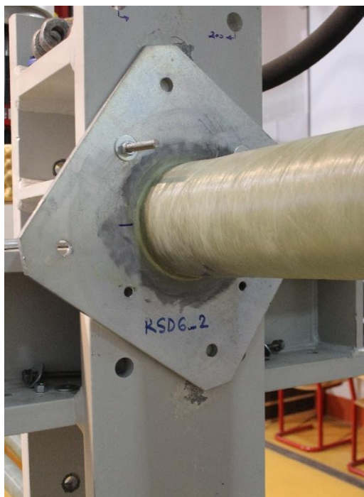
Slika 12. Pričvršćivanje vijcima da bi se ostvarila upetost
