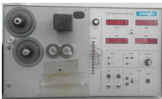
Slika 19. Uređaj za mjerenje dlakavosti tip G 565, Zweigle, Njemačka
