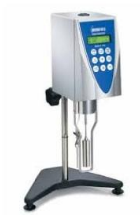
Slika 21. Viskozimetar Brookfield DV II+ [86]
