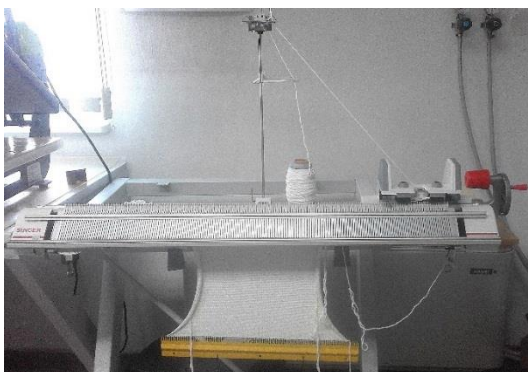
Slika 48. Izrada finalnog proizvoda na ručnom ravnopletaćem dvoigleničnom stroju za pletenje Singer
