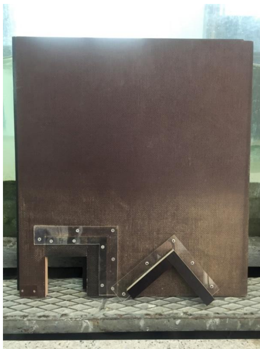
Slika 4.5 Pregrada s promjenjivim otvorima
