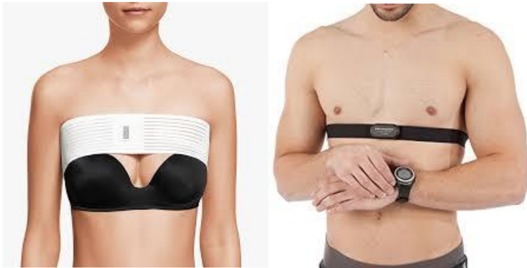
Sl. 10 Traka koja očitava puls povezana je pomoću Bluetooth tehnologije sa satom, računalom ili pametnim telefonom [19]
