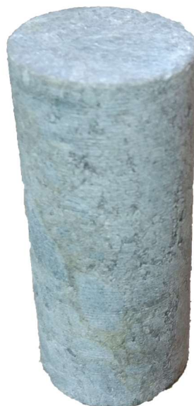
Slika 4-3 Uzorak 1 d = 3.75 \text{ cm} , h = 8.77 \text{ cm}
