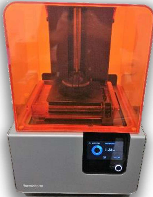
Slika 3-14 Stereolitografski 3D pisac
