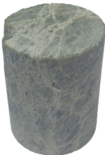
Slika 4-4 Uzorak 2 , d = 3.75 \text{ cm} , h = 4.77 \text{ cm}
