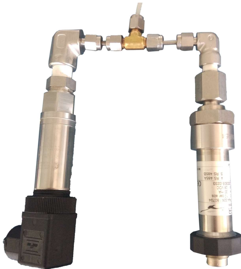
Slika 3-7 Mjerni pretvornik tlaka korišten prilikom umjeravanja INA-i
