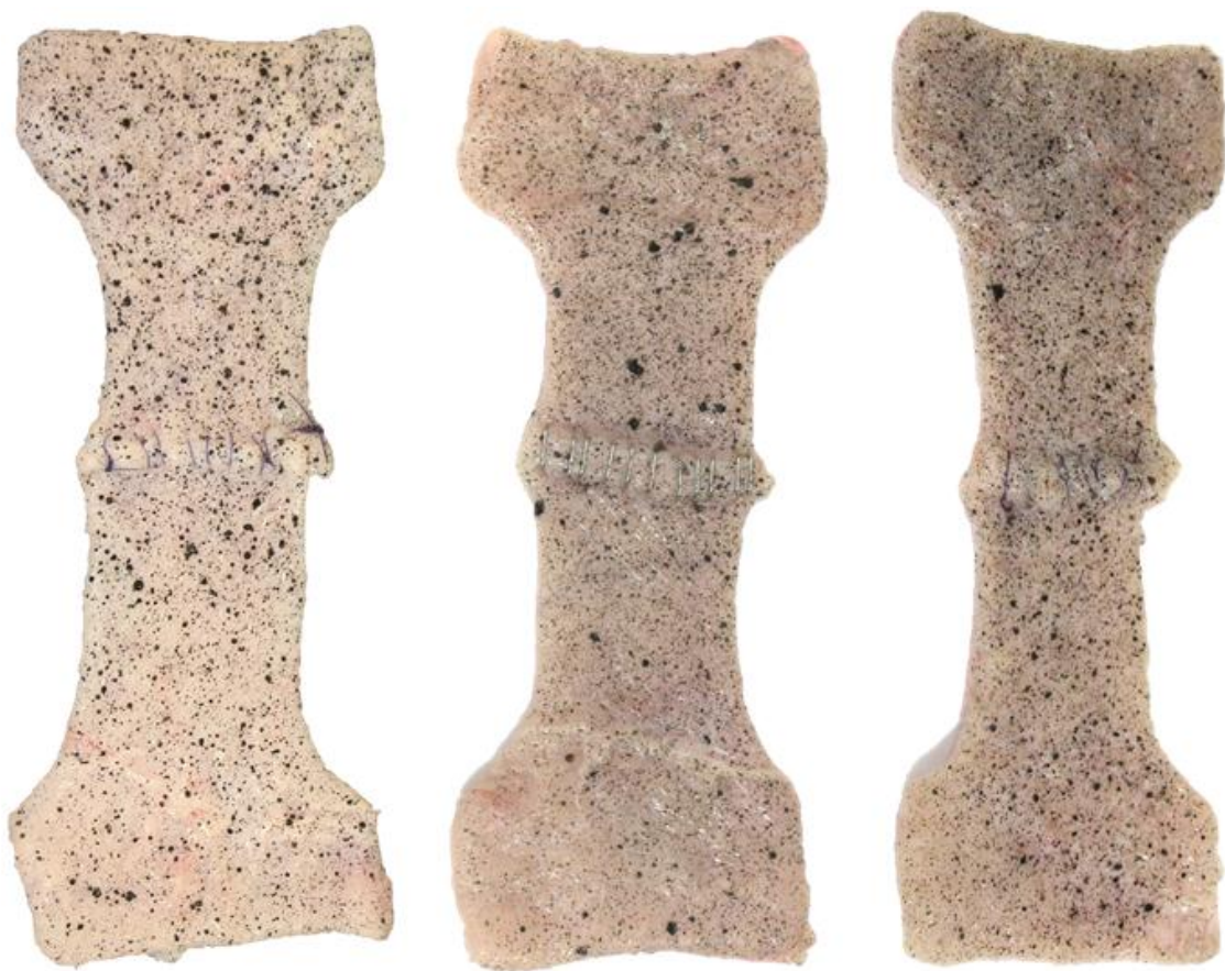
Slika 27 Uzorci pripremljeni za mjerenje optičkim sustavom Aramis
