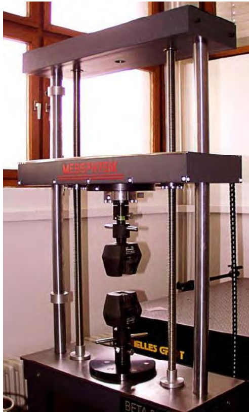
Slika 32 Statička kidalica Messphysik Beta 50-5
