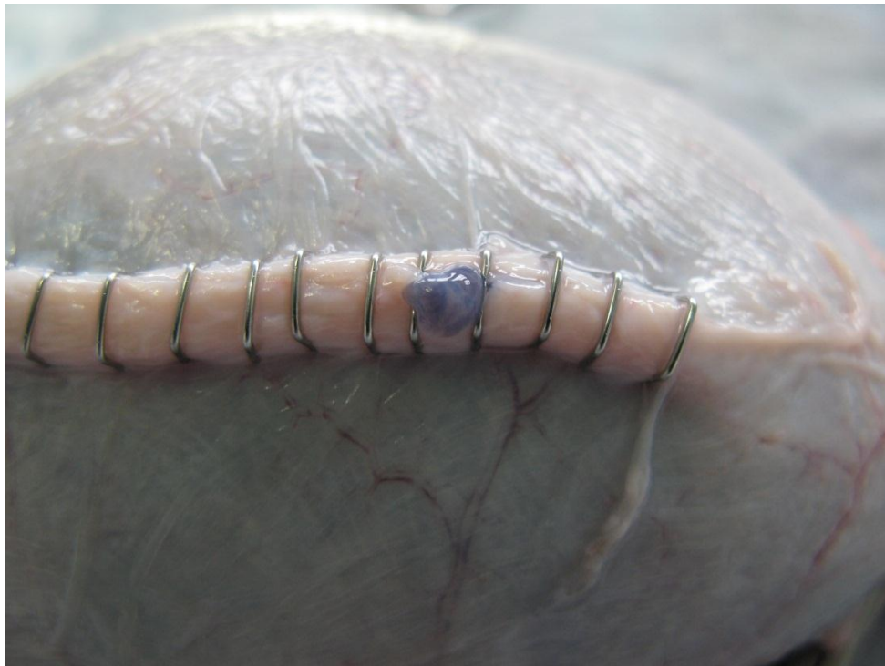
Slika 31 Uzorak u trenutku propuštanja – propuštanje između uboda
