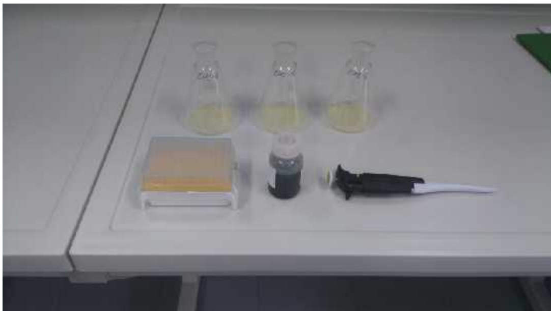
Slika 13. Uzorci celuloze u pripremljenoj otopini netom prije dodavanja kompleksa enzima
