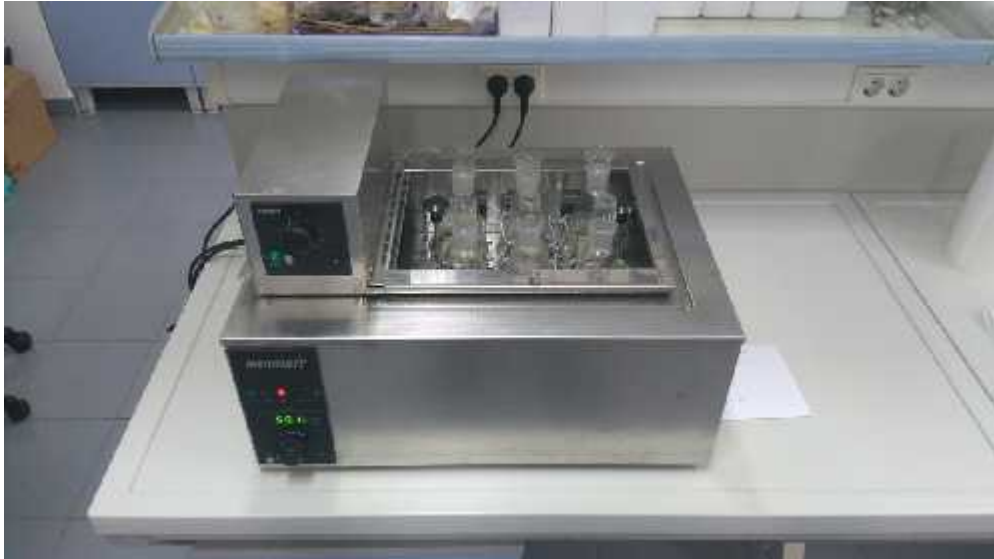
Slika 14. Uzorci spremni za potpuno enzimatske hidrolize u termostatisanoj kupelji s miješalicom
