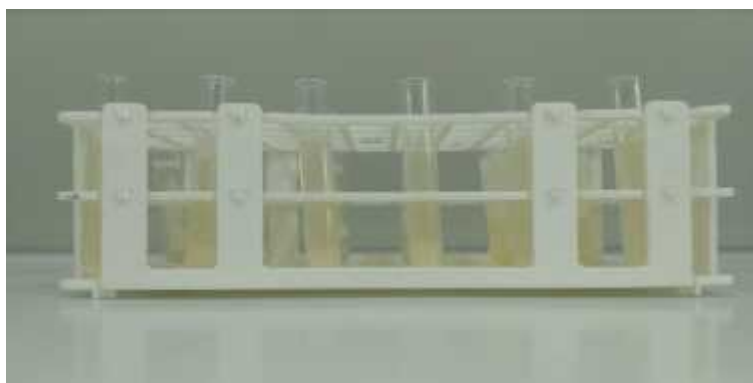
Slika 20. Nefiltrirani supernatant po završetku enzimatske hidrolize u trajanju od 72 sata
