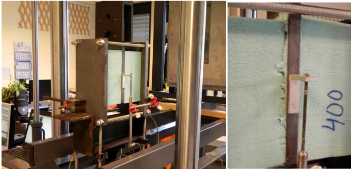
Slika 19. Posmični test primijenjen na posmičnom stroju [17]
