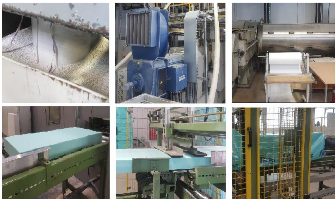
Slika 11. Proces proizvodnje XPS-a
