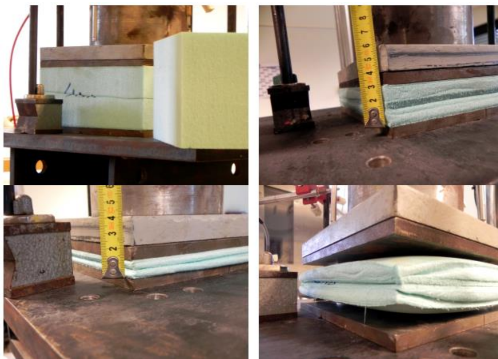
Slika 14. Faze opterećenja/rasterećenja uzorka XPS 400-L[17]
