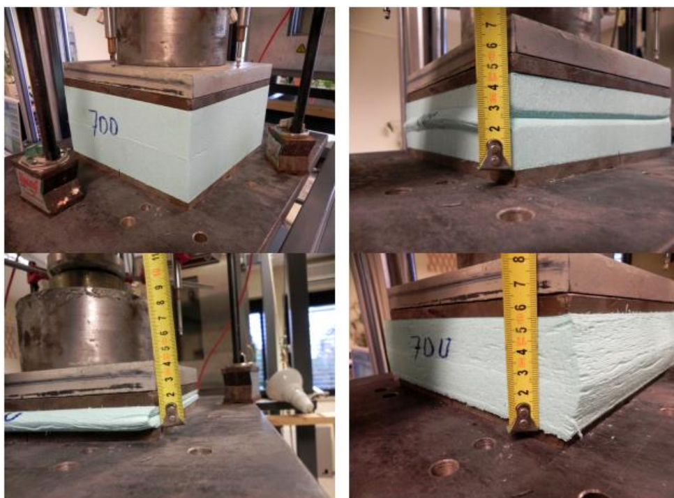
Slika 17. Faze opterećenja/rasterećenja uzorka XPS 700-L [17]
