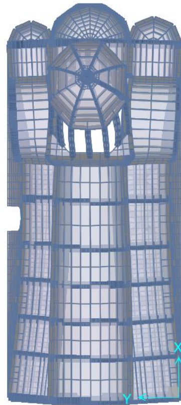
Slika 62 Trodimenzijski, bočni i tlocrtni prikaz drugog vlastitog oblika titranja (5,62 Hz)
