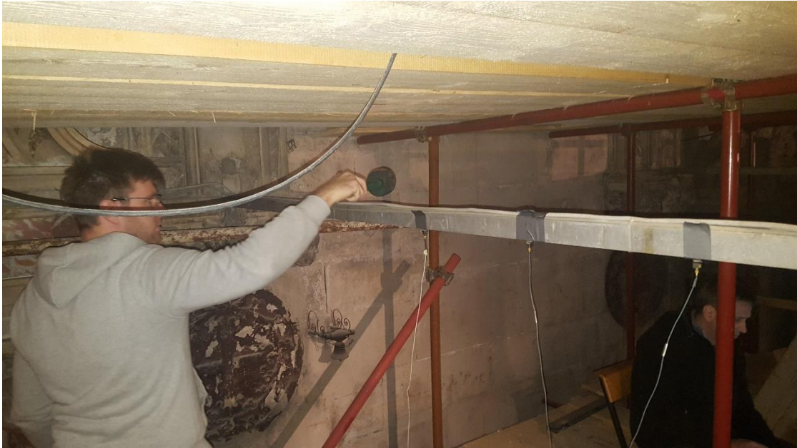
Slika 22 Pobuđivanje zatege C-D 3 na titranje pomoću udarnog čekića
