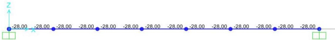
Slika 39 Vlačno opterećenje štapa u obliku temperature (-28 °C)
