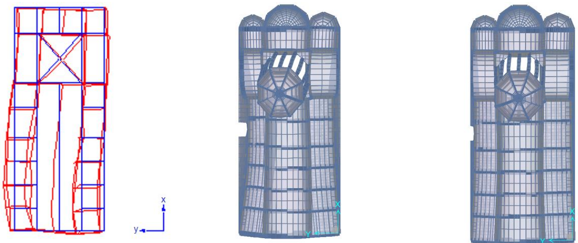
Slika 91 Usporedba trećeg modalnog oblika (eksperimentalno ispitivanje, model sa zategama, model bez zatega)
