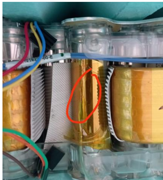
Slika 12 Prikaz ugrađenog termopara 2 na baterijskoj ćeliji
