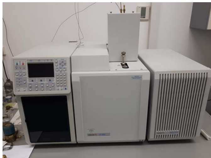
Slika D3 Varian Saturn 2200 GC-MS uređaj na kojem su snimani uzorci
