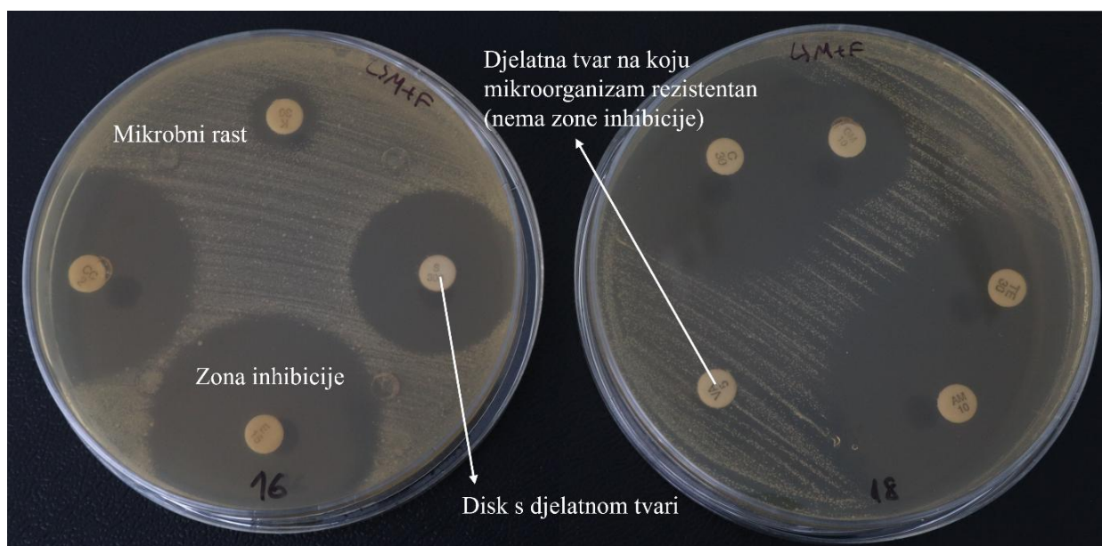
Slika 6. Metoda disk difuzije (Kirby-Bauer postupak): celulozni disokvi natopljeni djelatnom tvari koja inhibira (očituje se pojavom zone inhibicije oko diska) ili ne inhibira (nema zone inhibicije oko diska) mikrobni rast
