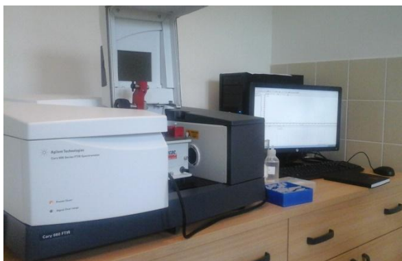
Slika 16. Infracrveni (FTIR) spektrometar (lijevo) i analiza uzoraka pčelinjeg kruha FTIR-ATR tehnikom snimanja (desno)
